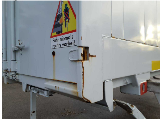
Gebrauchsspur 1: Karosserie: Karosserie - beschädigt - kein Abzug
