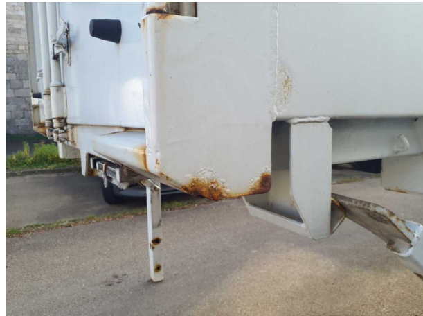
Beschädigung 1: Aufbau: Aufbau - Korrosion - instandsetzen und lackieren
