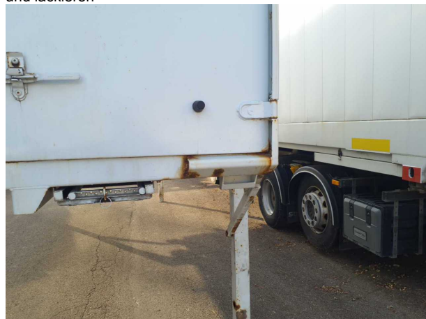
Beschädigung 1: Aufbau: Aufbau - Korrosion - instandsetzen und lackieren
