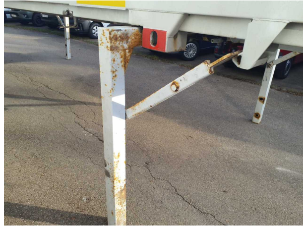
Beschädigung 1: Aufbau: Aufbau - Korrosion - instandsetzen und lackieren
