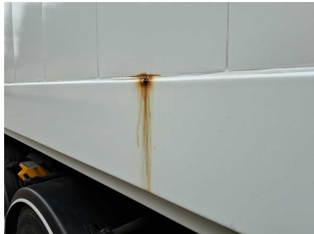
Beschädigung 1: Aufbau: Aufbau - Korrosion - lackieren
