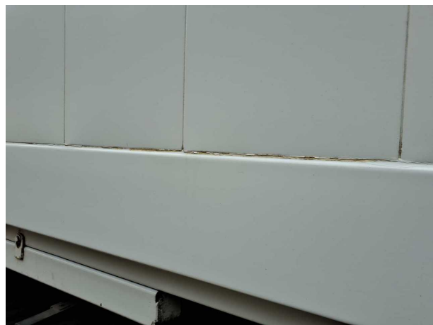
Beschädigung 1: Aufbau: Aufbau - Korrosion - lackieren
