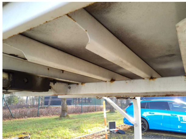
Gebrauchsspur 1: Karosserie: Karosserie - Korrosion - kein Abzug
