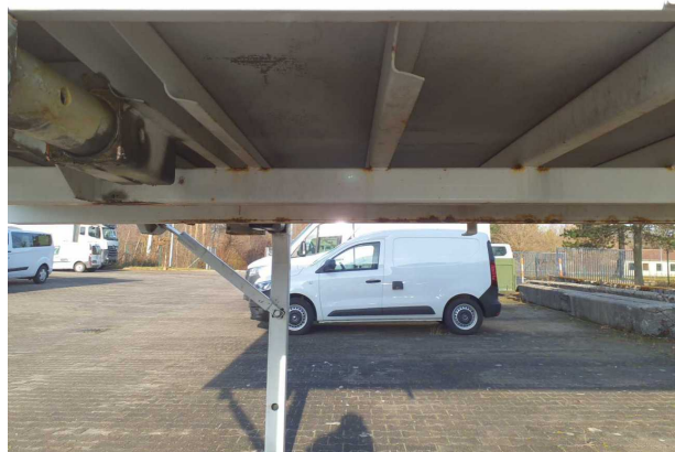
Gebrauchsspur 1: Karosserie: Karosserie - Korrosion - kein Abzug
