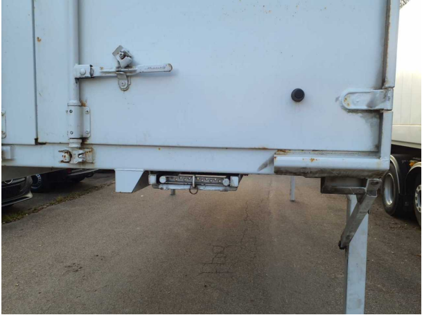
Beschädigung 1: Aufbau: Aufbau - Korrosion - instandsetzen und lackieren
