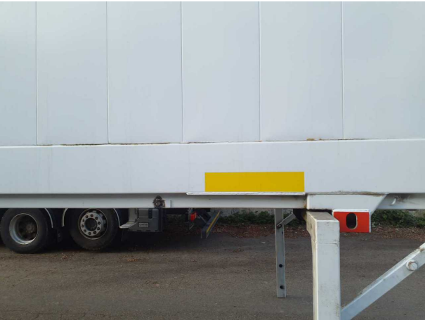
Beschädigung 1: Aufbau: Aufbau - Korrosion - instandsetzen und lackieren
