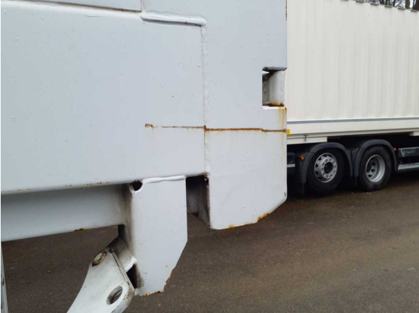
Beschädigung 2: Aufbau: Aufbau - Korrosion - instandsetzen und lackieren
