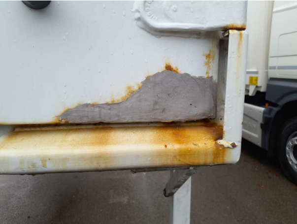
Beschädigung 1: Tür hinten rechts: Tür unterhalb - beschädigt - instandsetzen und lackieren
