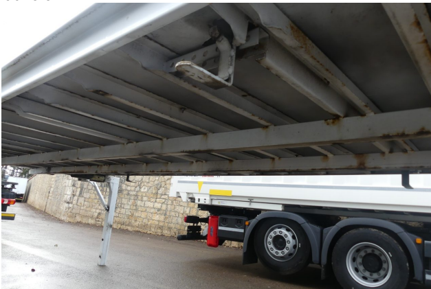
Beschädigung 1: Aufbau: Aufbau - Korrosion - instandsetzen und lackieren
