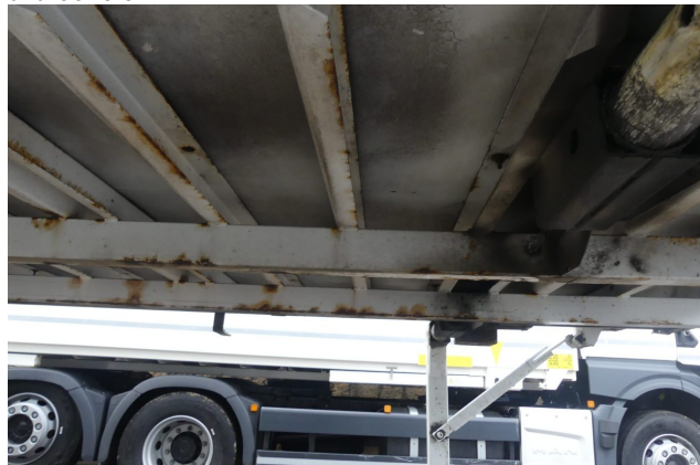
Beschädigung 1: Aufbau: Aufbau - Korrosion - instandsetzen und lackieren
