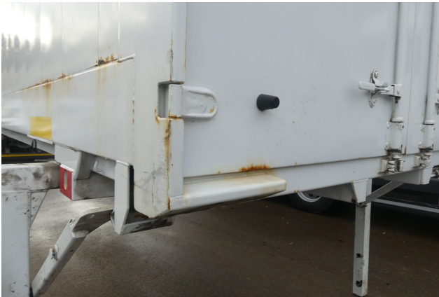
Beschädigung 1: Aufbau: Aufbau - Korrosion - instandsetzen und lackieren
