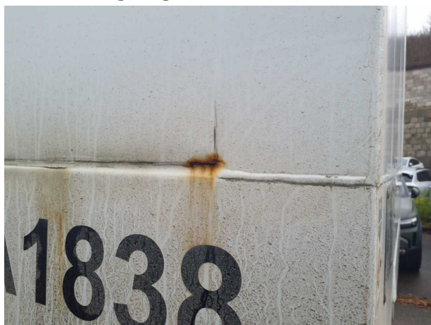
Gebrauchsspur 1: Aufbau: Aufbau - Korrosion - kein Abzug
