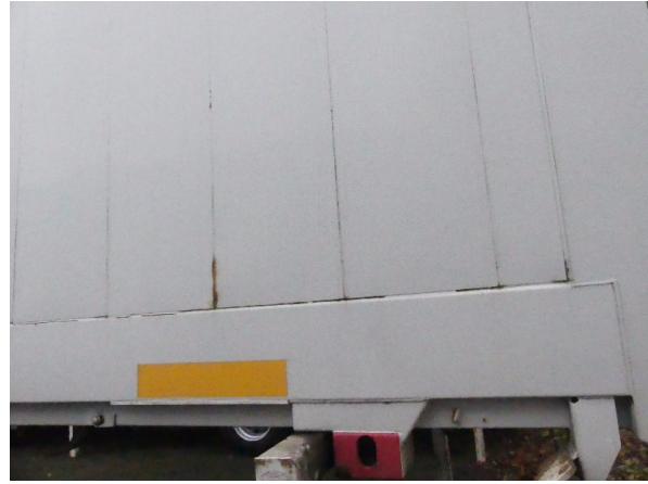
Bild 20: Seitenwand rechts Korrosion - lackieren
