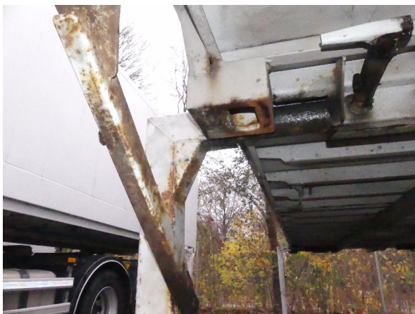
Bild 23: Rahmen und Stützbeine Korrosion - ohne Reparatur
