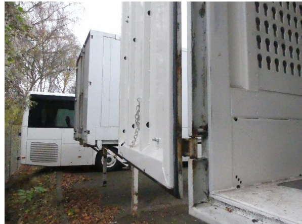
Bild 10: Tür links Korrosion - teillackieren
