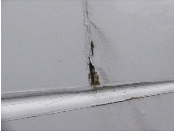
Bild 31: Seitenwand links Rostansatz - teillackieren
