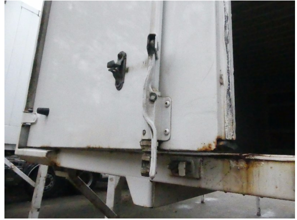
Bild 14: Tür links Korrosion - teillackieren
