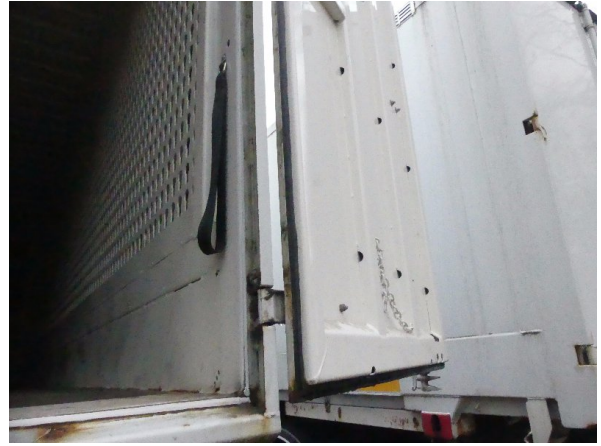
Bild 20: Tür rechts Korrosion - teillackieren
