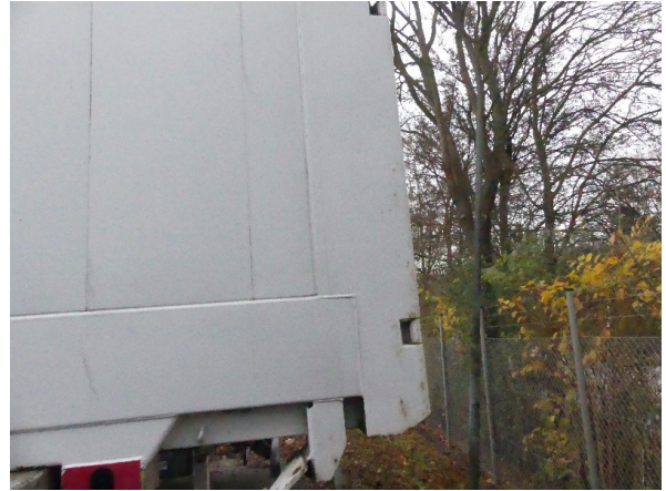
Bild 32: Portalrahmen links Flugrost - teillackieren
