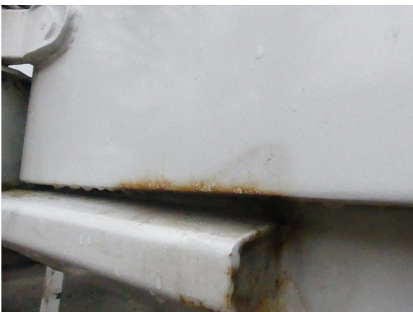
Bild 17: Tür links Korrosion - teillackieren
