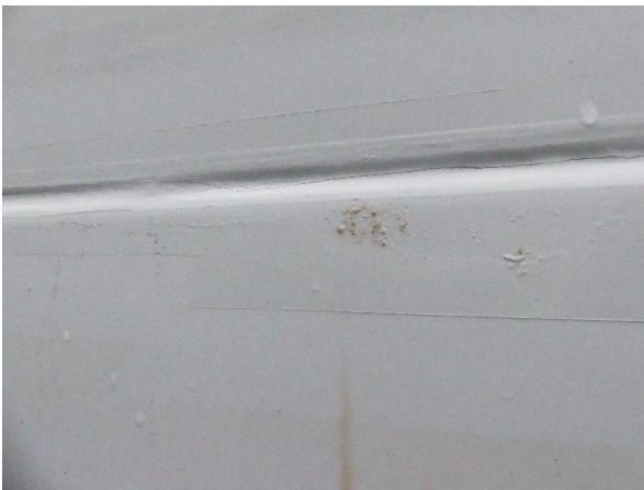
Bild 27: Seitenwand rechts Lackabplatzung - teillackieren
