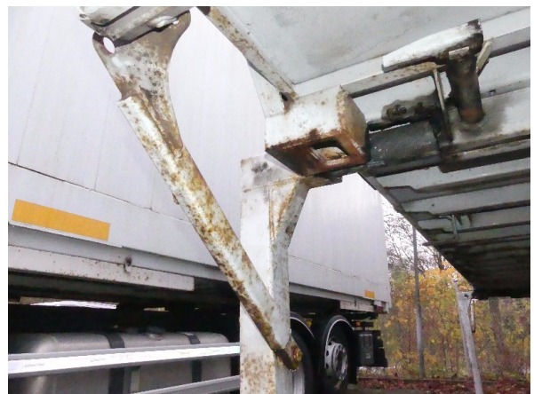
Bild 6: Rahmen und Stützbeine Korrosion - ohne Reparatur
