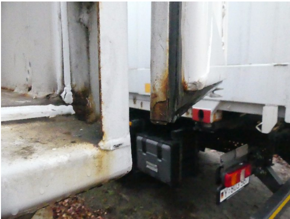
Bild 21: Tür rechts Korrosion - teillackieren
