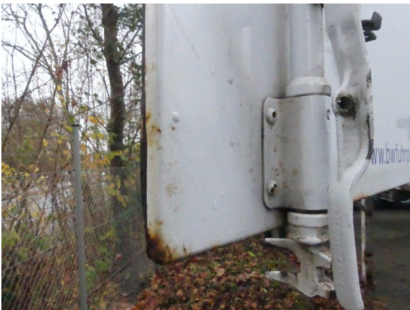
Bild 23: Tür rechts Korrosion - teillackieren
