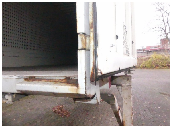
Bild 12: Tür rechts Korrosion - teillackieren
