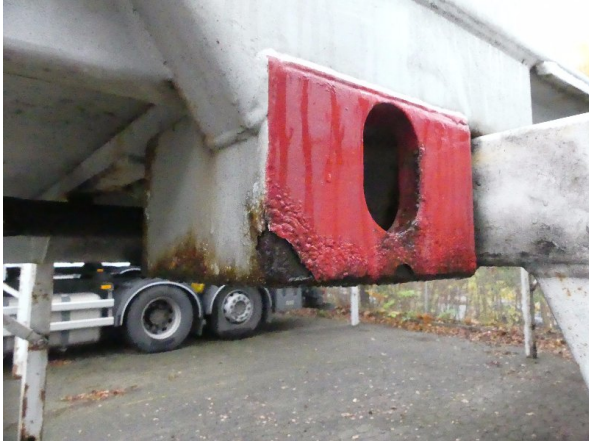
Bild 27: Seitenwand links Rostansatz, Korrosionsschaden nicht sach,- fachgerecht instandgesetzt, Korrosion - teillackieren
