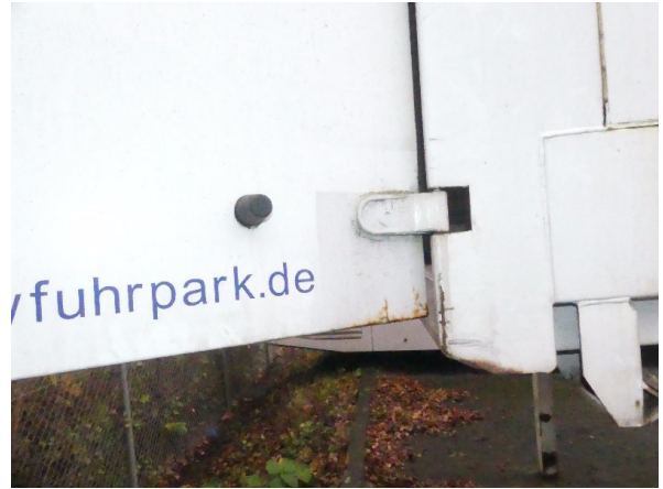
Bild 14: Tür rechts Korrosion - teillackieren
