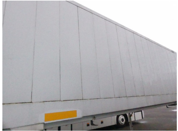
Bild 20: Seitenwand rechts Nahtabdichtung fehlt - instandsetzen
