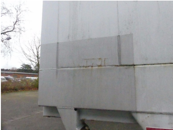
Bild 25: Seitenwand links Rostansatz, Korrosionsschaden nicht sach,- fachgerecht instandgesetzt, Korrosion - teillackieren
