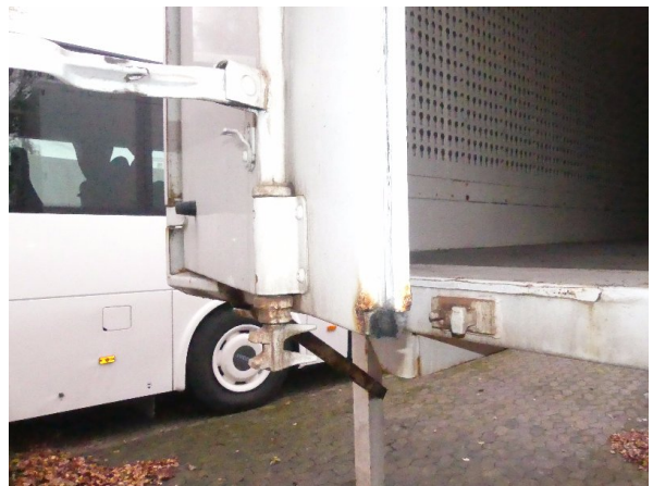
Bild 10: Tür links Korrosion - teillackieren
