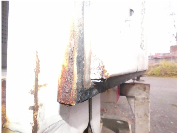
Bild 13: Tür rechts Korrosion - teillackieren
