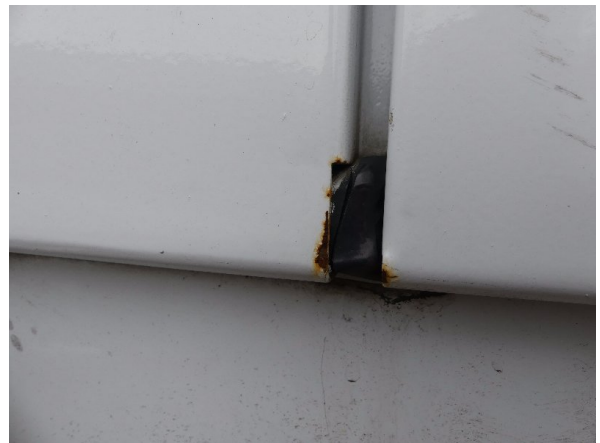
Bild 22: Hecktür links Korrosion - Smart Repair
