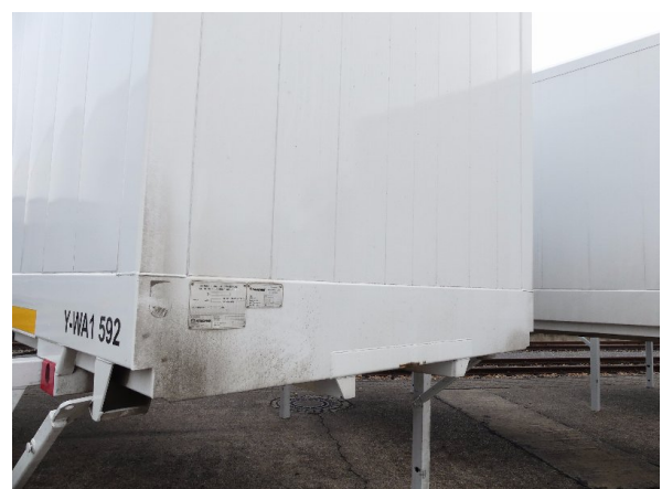
Bild 12: Frontwand Korrosion - instandsetzen und lackieren
