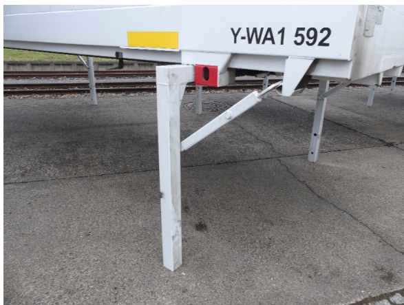
Bild 31: Karosserie Delle / Kratzer / Abschürfung ohne Reparatur
