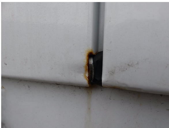
Bild 27: Hecktür links Korrosion - Smart Repair
