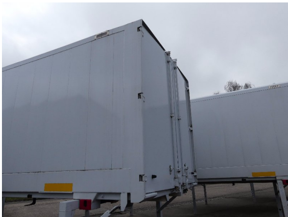
Bild 25: Eckbeplankung links Abschürfung - instandsetzen und lackieren
