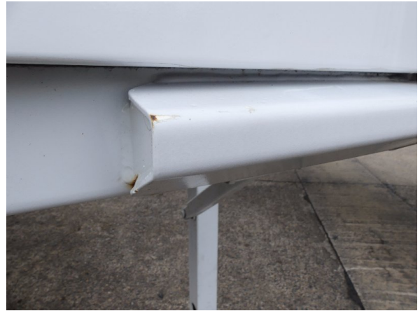
Bild 24: Eckbeplankung rechts Abschürfung - instandsetzen und lackieren
