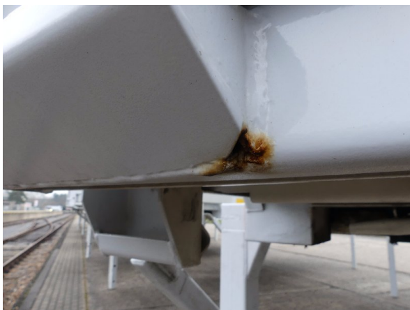
Bild 27: Eckbeplankung links Abschürfung - instandsetzen und lackieren
