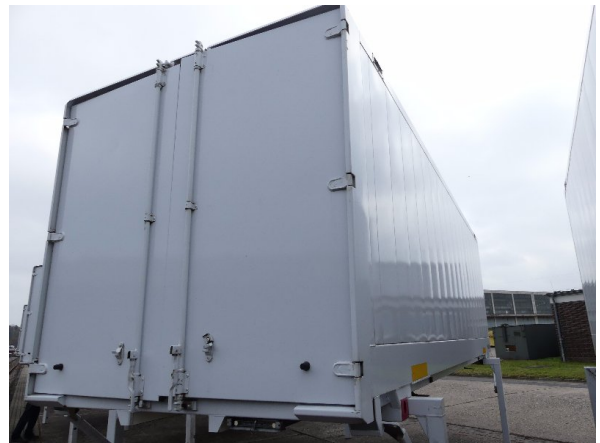
Bild 22: Eckbeplankung rechts Abschürfung - instandsetzen und lackieren
