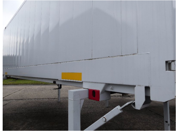
Bild 20: Abdichtung Frontwand, Seitenwand links und rechts beschädigt - erneuern
