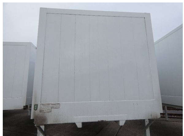
Bild 12: Frontbereich Kratzer/Korrosion - instandsetzen und lackieren
