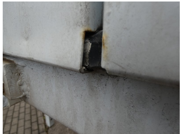
Bild 16: Heckbereich Kratzer/Korrosion - instandsetzen und lackieren
