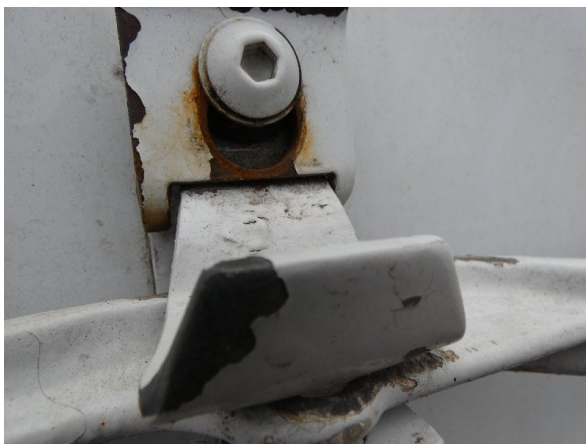
Bild 17: Heckbereich Kratzer/Korrosion - instandsetzen und lackieren
