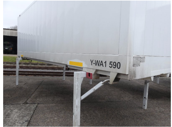
Bild 14: Abdichtung links und rechts beschädigt - erneuern
