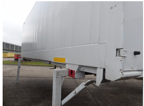
Bild 16: Abdichtung links und rechts beschädigt - erneuern
