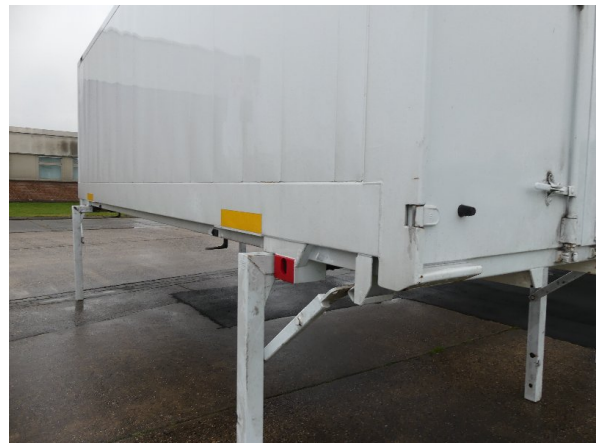
Bild 16: Abdichtung links und rechts beschädigt - erneuern
