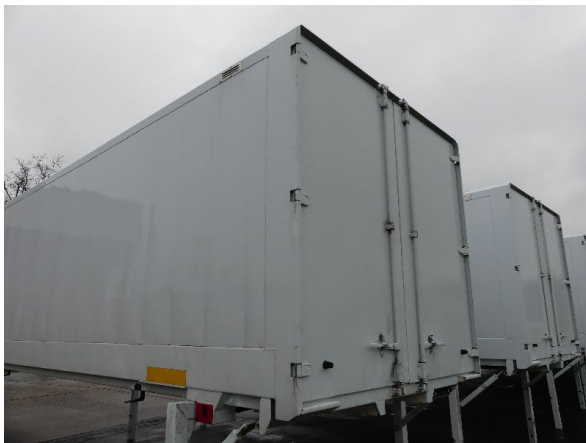
Bild 25: Eckbeplankung links Korrosion - instandsetzen und lackieren
