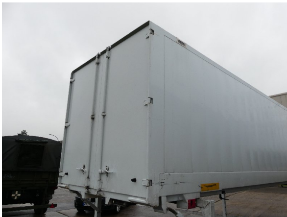
Bild 21: Eckbeplankung rechts Korrosion - instandsetzen und lackieren
