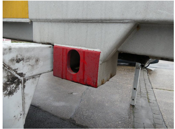
Bild 34: Aufnahmen Korrosion - instandsetzen und lackieren
