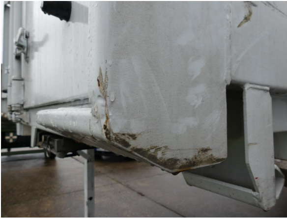
Bild 23: Eckbeplankung rechts Korrosion - instandsetzen und lackieren
