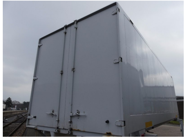
Bild 24: Hecktür rechts Korrosion - instandsetzen und lackieren
