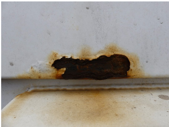
Bild 25: Hecktür rechts Korrosion - instandsetzen und lackieren
