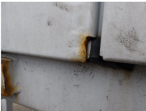
Bild 27: Hecktür links Korrosion - instandsetzen und lackieren
