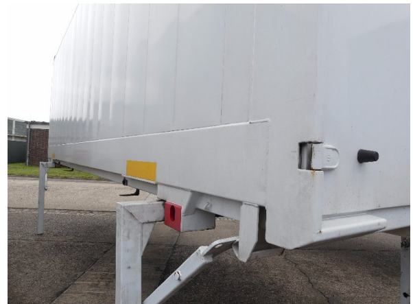
Bild 16: Abdichtung Seitenwand links und rechts beschädigt - erneuern
