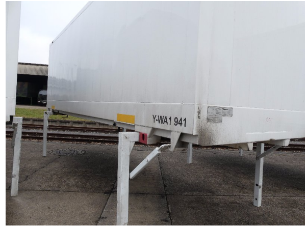
Bild 14: Abdichtung Seitenwand links und rechts beschädigt - erneuern
