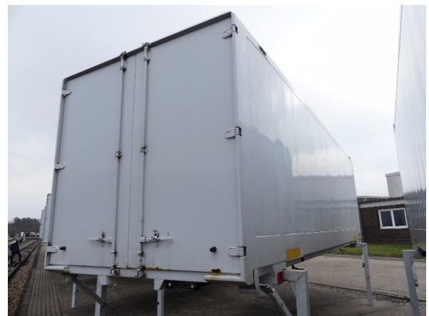
Bild 18: Eckbeplankung rechts Korrosion - instandsetzen und lackieren
