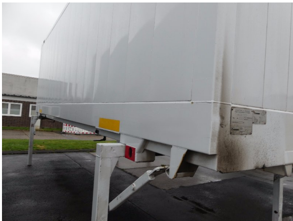
Bild 15: Abdichtung links und rechts beschädigt - erneuern
