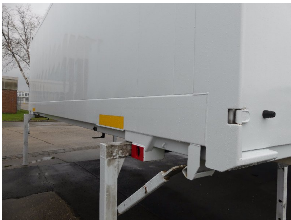
Bild 17: Abdichtung links und rechts beschädigt - erneuern
