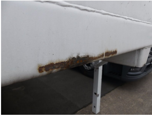
Bild 13: Frontwand Korrosion - instandsetzen und lackieren
