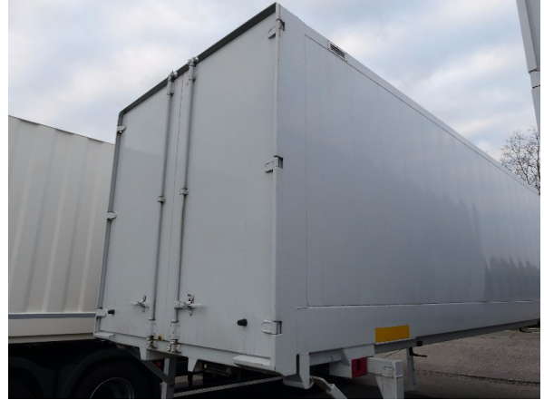
Bild 20: Eckbeplankung rechts Abschürfungen / Korrosion - instandsetzen und lackieren
