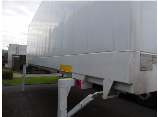
Bild 14: Abdichtung links und rechts beschädigt - erneuern
