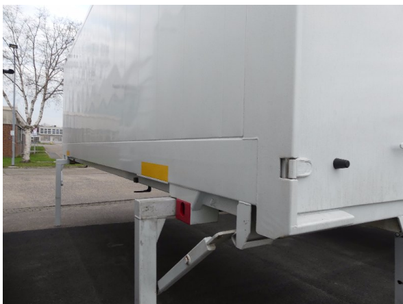
Bild 17: Abdichtung links und rechts beschädigt - erneuern
