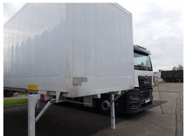
Bild 12: Frontwand Korrosion - instandsetzen und lackieren
