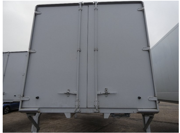
Bild 14: Heckbereich Kratzer/Korrosion - instandsetzen und lackieren
