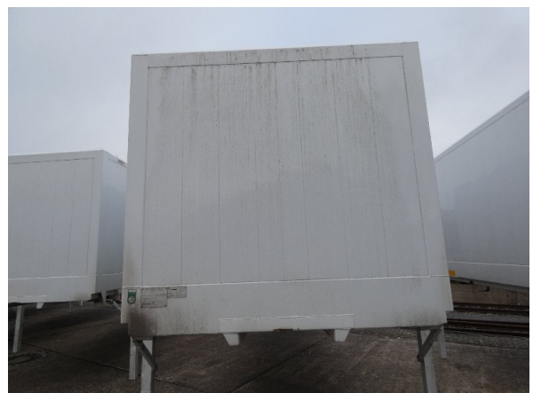
Bild 12: Frontbereich Kratzer/Korrosion - instandsetzen und lackieren
