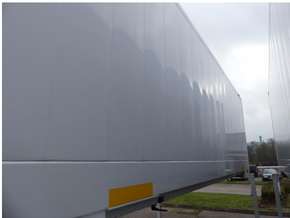
Bild 25: Seitenwand links Dellen / Beulen - sanft instandsetzen
