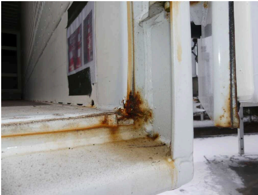
Bild 20 Fahrzeugheck Rahmen hinten links stark korrodiert
