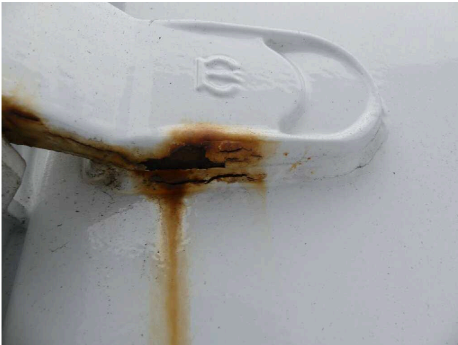
Bild 26 Fahrzeugheck Heckflügeltür links stark korrodiert
