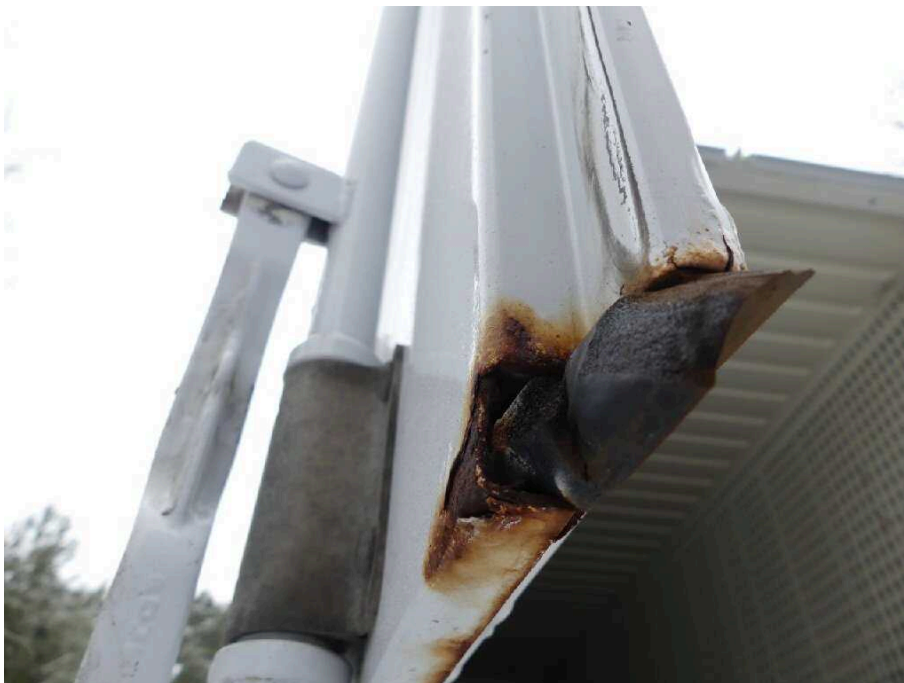
Bild 28 Fahrzeugheck Heckflügeltür links stark korrodiert
