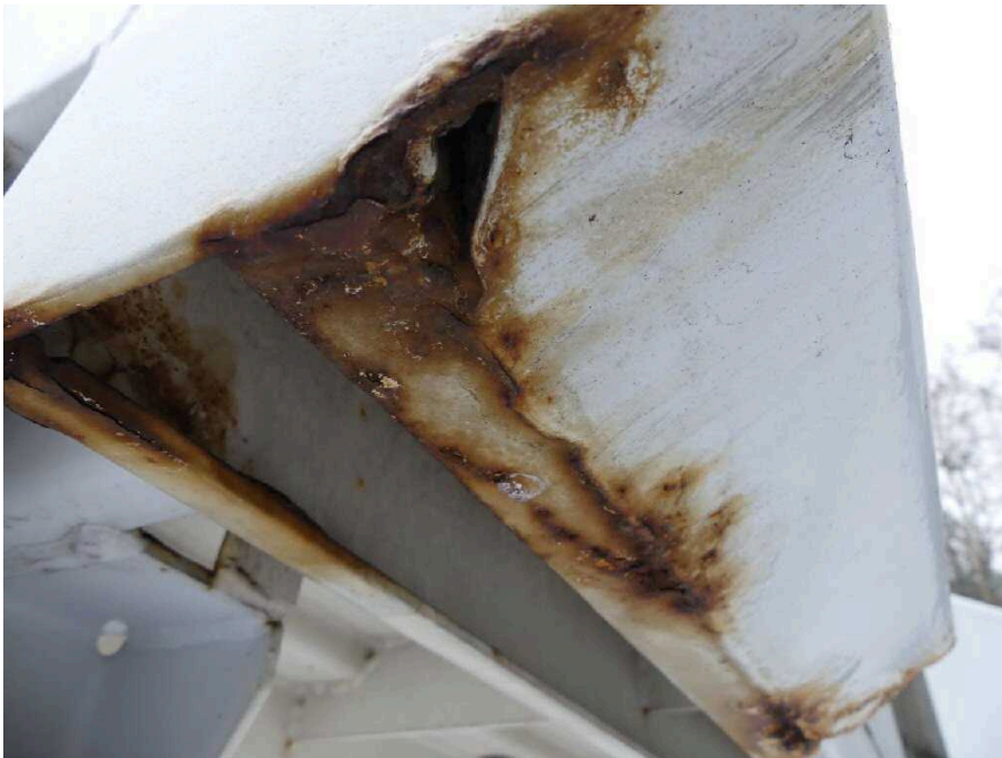
Bild 34 Fahrzeugeck Rahmen hinten links stark korrodiert
