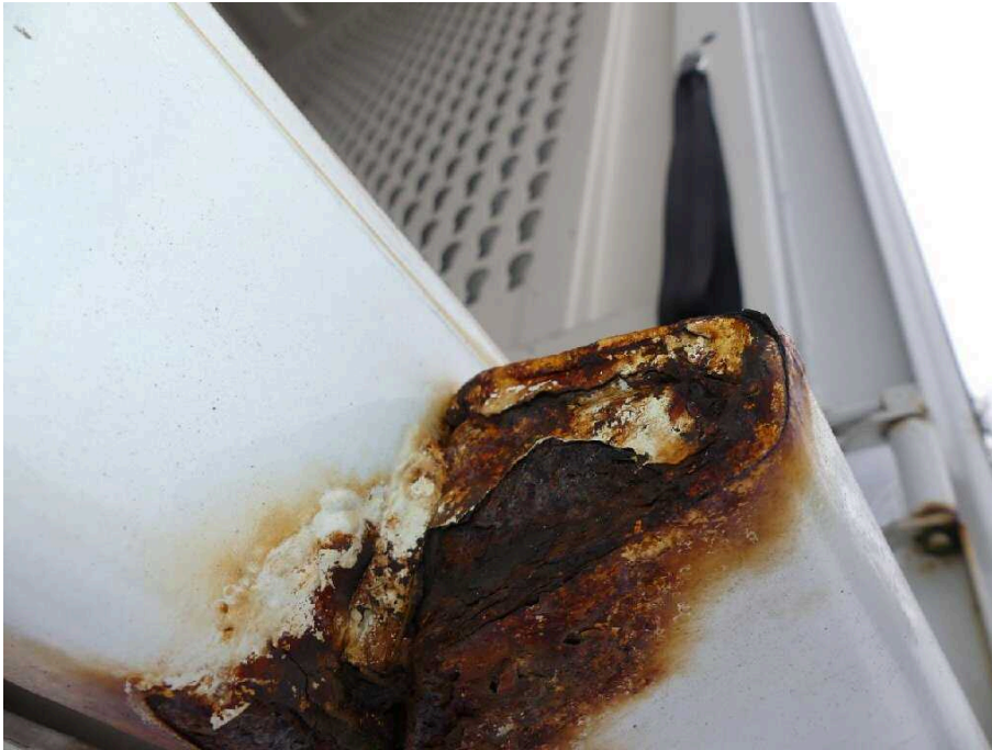
Bild 21 Fahrzeugheck Rahmen hinten links stark korrodiert
