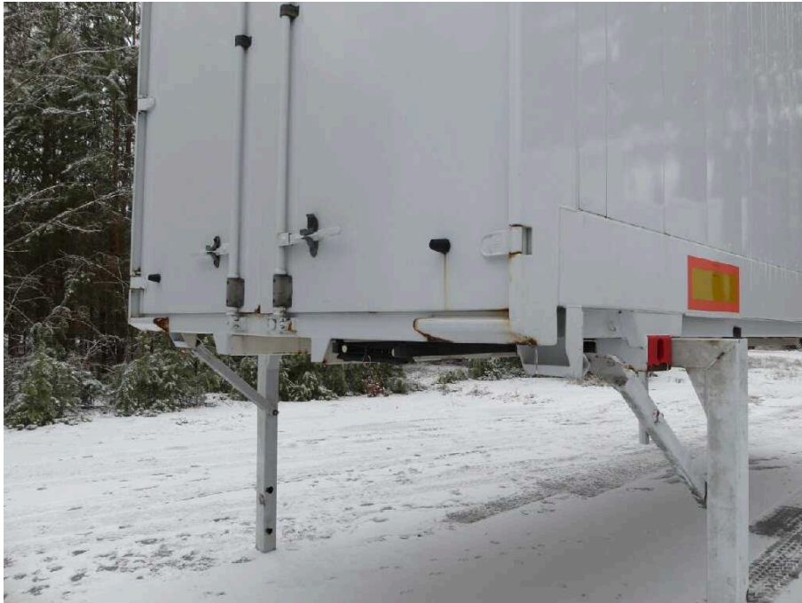
Bild 15 Fahrzeugheck Rahmen hinten links stark korrodiert
