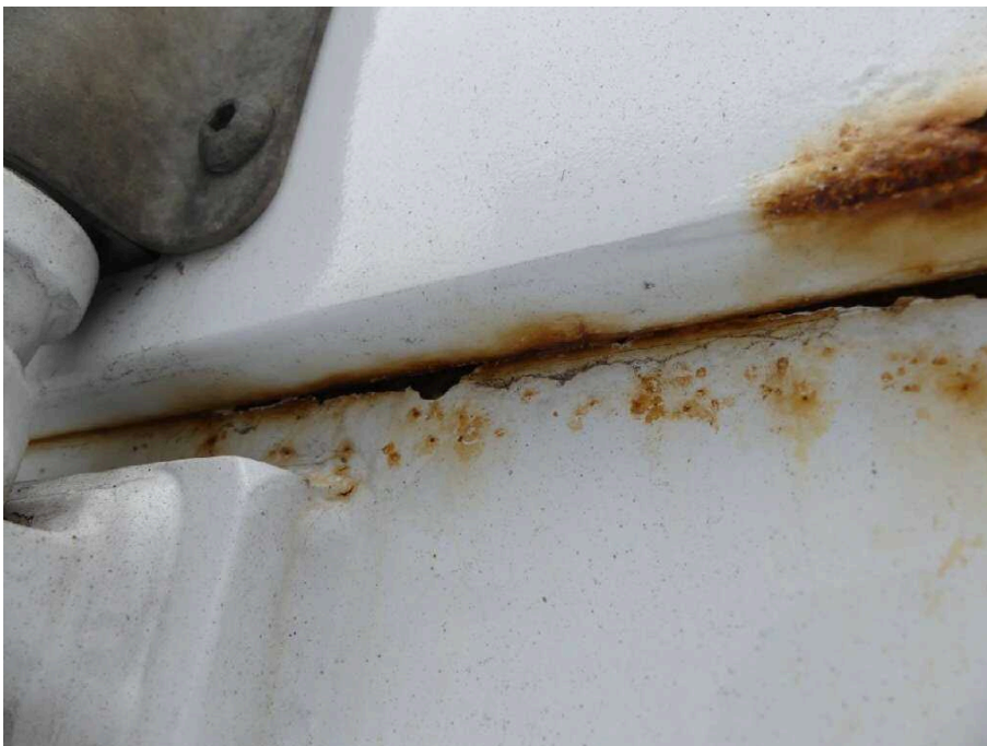
Bild 24 Fahrzeugheck Heckflügeltür links stark korrodiert
