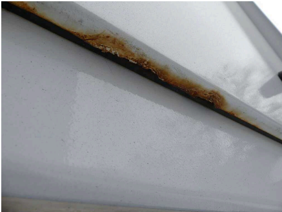
Bild 37 Fahrzeugheck Heckflügeltür rechts stark korrodiert
