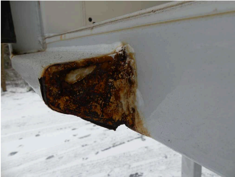
Bild 35 Fahrzeugheck Rahmen hinten links stark korrodiert
