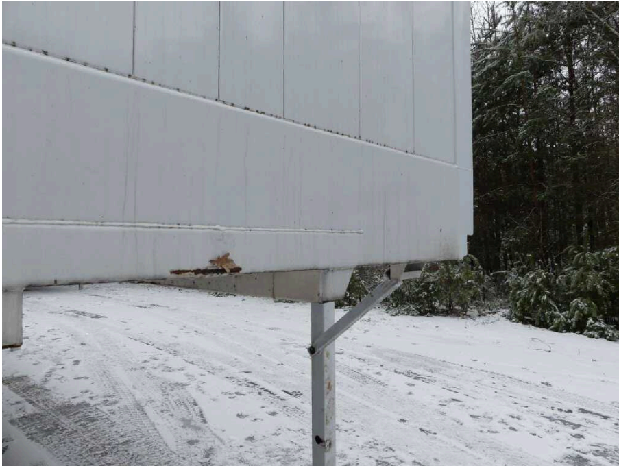
Bild 9 Aufbau Bodenrahmen vorne korrodiert
