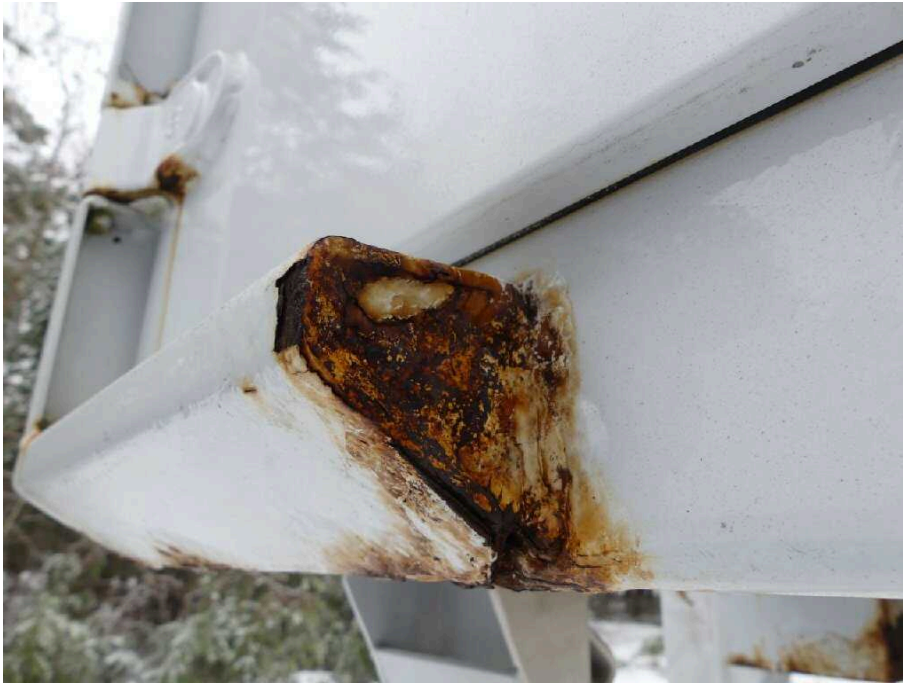
Bild 31 Fahrzeugeheck Rahmen hinten links stark korrodiert
