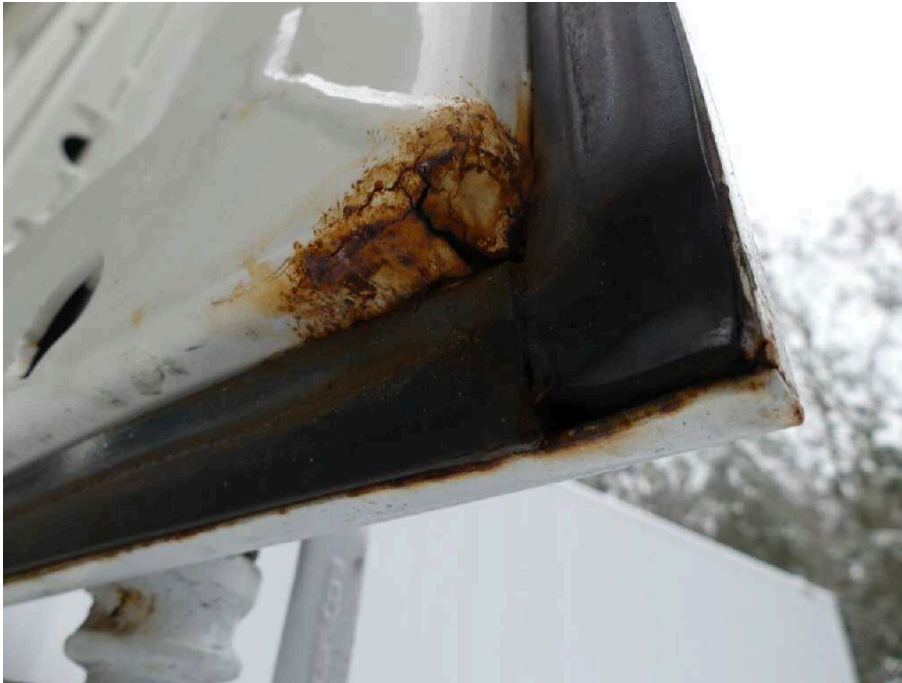
Bild 39 Fahrzeugheck Heckflügeltür rechts stark korrodiert
