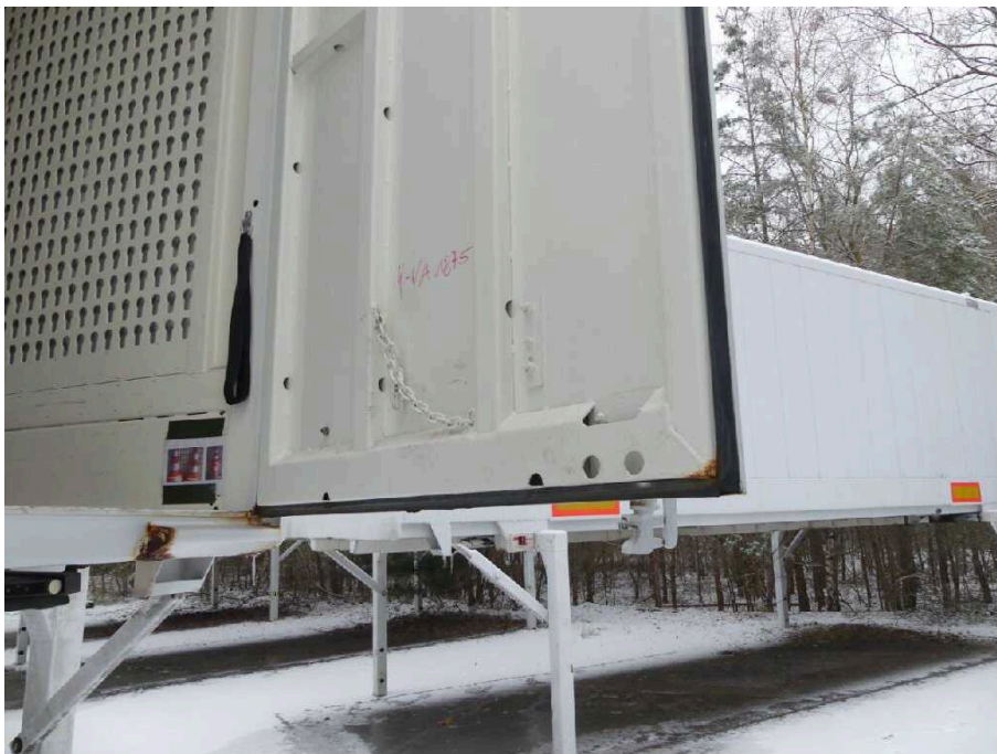
Bild 38 Fahrzeugheck Heckflügeltür rechts stark korrodiert
