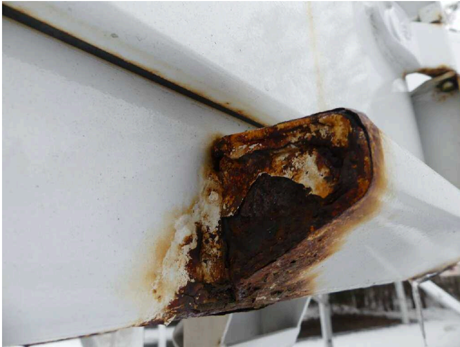
Bild 19 Fahrzeugheck Rahmen hinten links stark korrodiert
