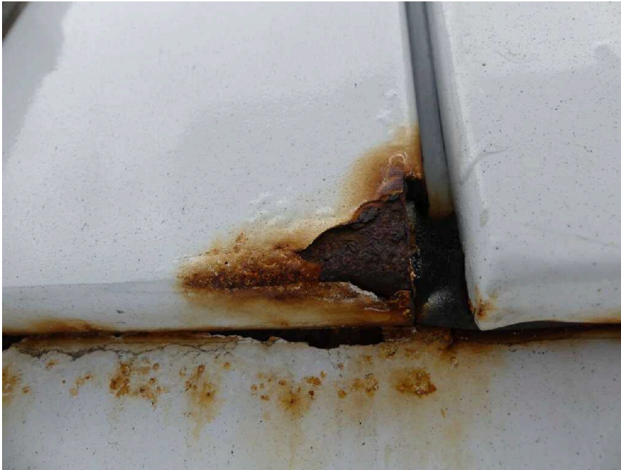
Bild 25 Fahrzeugheck Heckflügeltür links stark korrodiert
