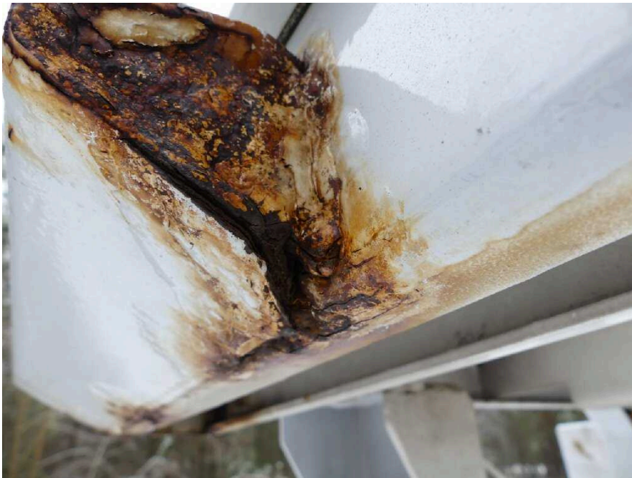
Bild 32 Fahrzeugeheck Rahmen hinten links stark korrodiert
