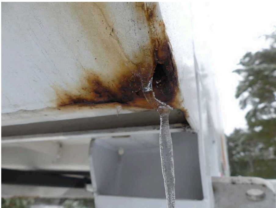
Bild 16 Fahrzeugheck Rahmen hinten links stark korrodiert
