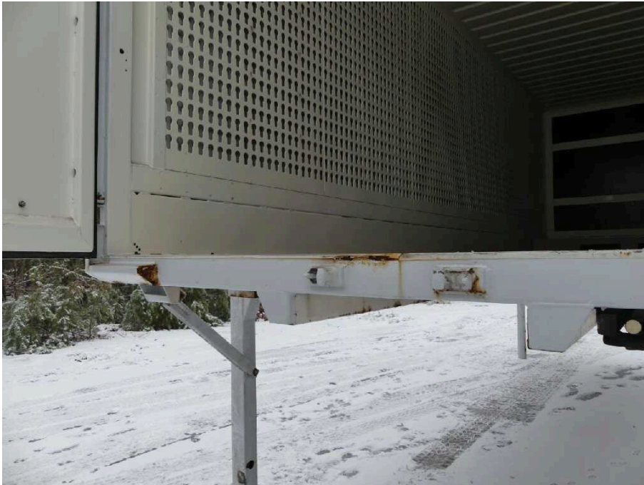
Bild 41 Fahrzeugeheck Rahmen hinten Mitte stark korrodiert
