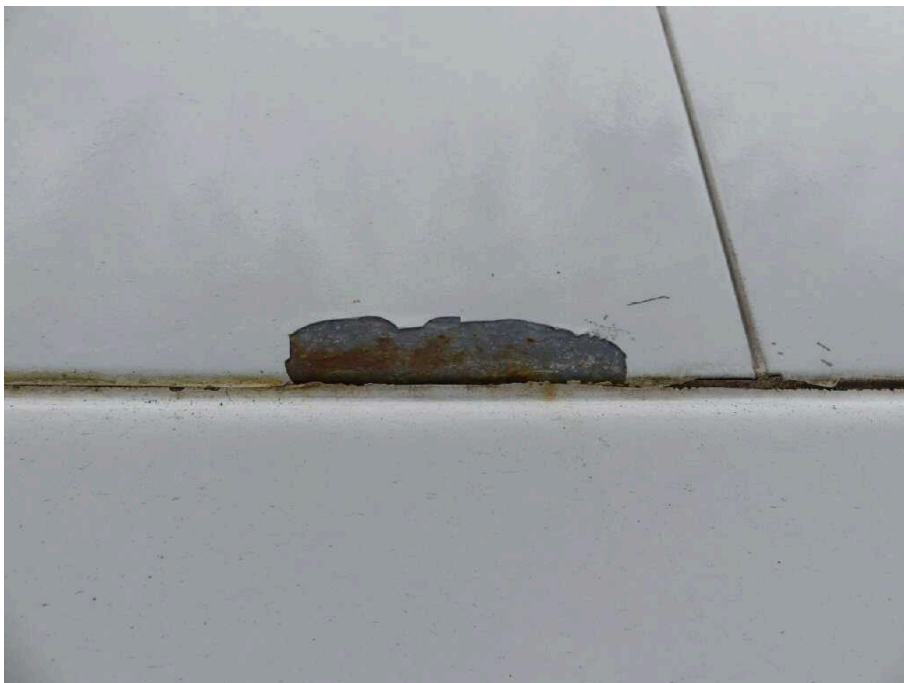
Bild 12 linke Seite Seitenteil hinten links stark korrodiert
