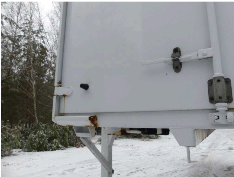
Bild 30 Fahrzeugheck Rahmen hinten links stark korrodiert
