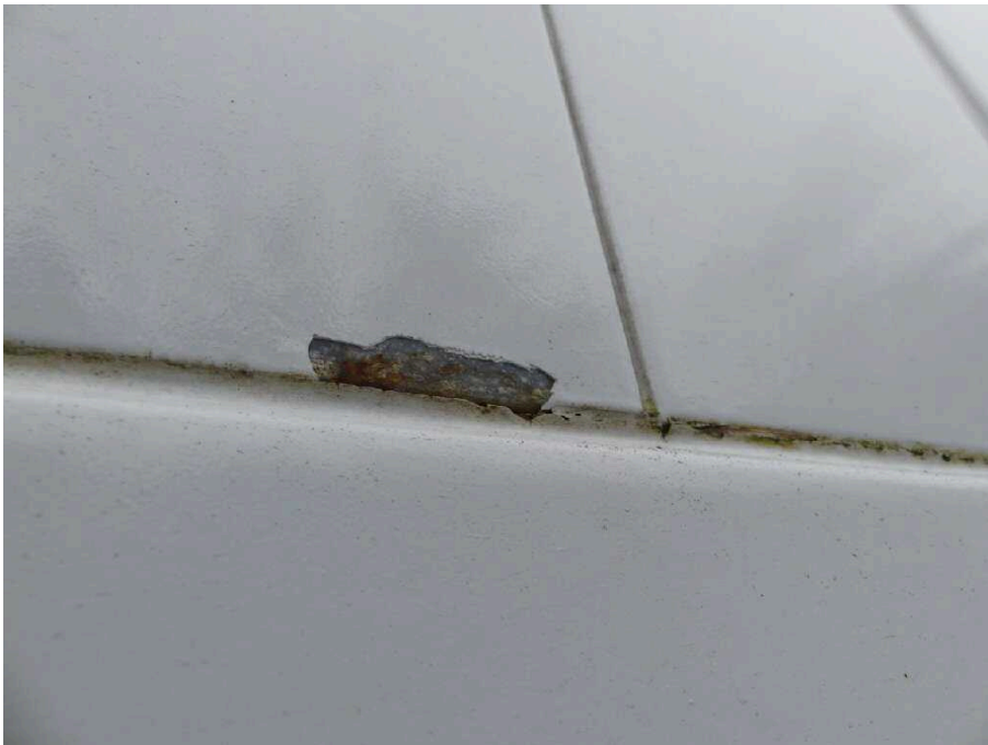
Bild 14 linke Seite Seitenteil hinten links stark korrodiert
