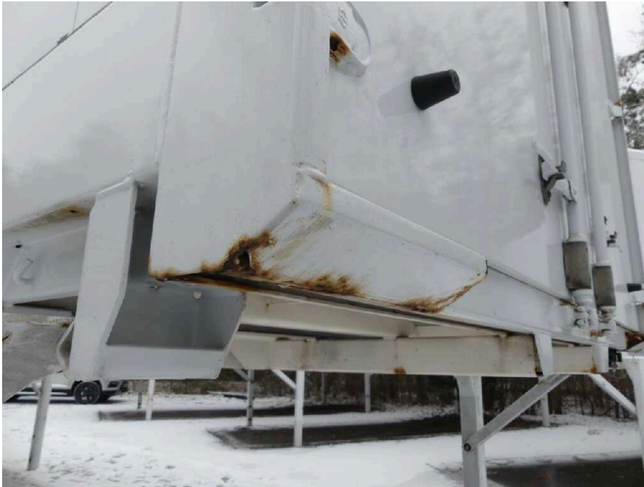
Bild 33 Fahrzeugeck Rahmen hinten links stark korrodiert
