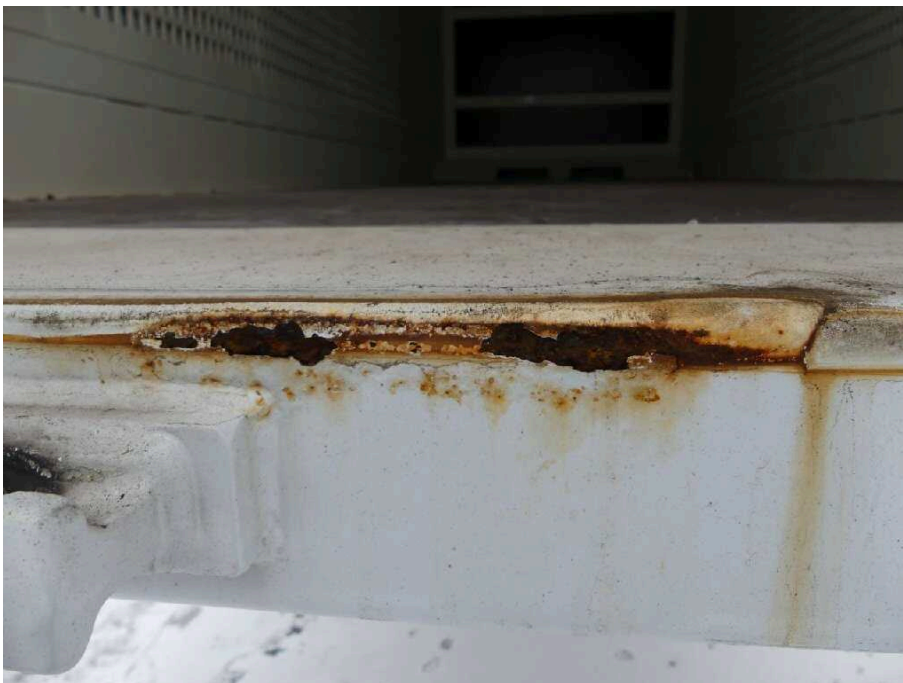
Bild 42 Fahrzeugeheck Rahmen hinten Mitte stark korrodiert
