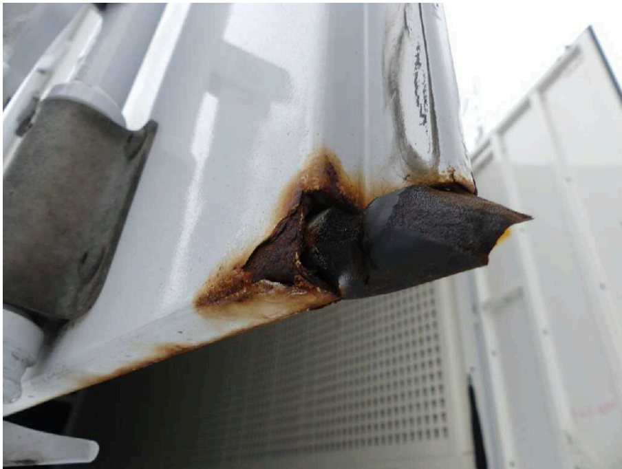
Bild 27 Fahrzeugheck Heckflügeltür links stark korrodiert
