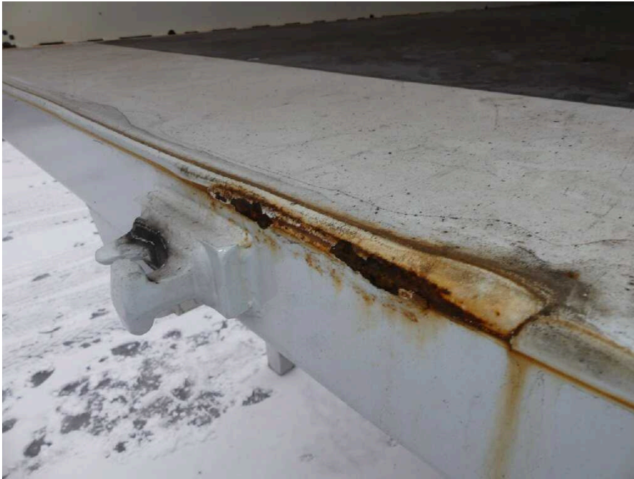
Bild 43 Fahrzeugheck Rahmen hinten Mitte stark korrodiert
