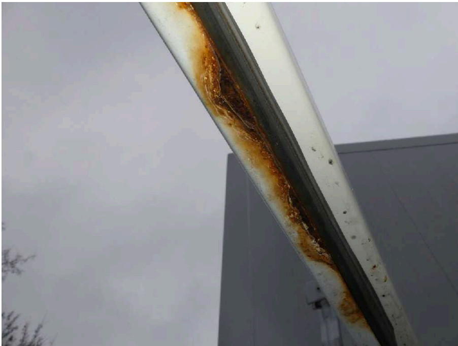
Bild 40 Fahrzeugheck Heckflügeltür rechts stark korrodiert
