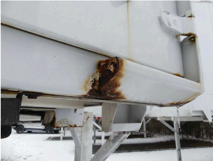
Bild 17 Fahrzeugeheck Rahmen hinten links stark korrodiert
