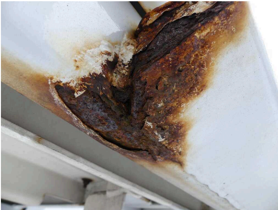
Bild 18 Fahrzeugeheck Rahmen hinten links stark korrodiert
