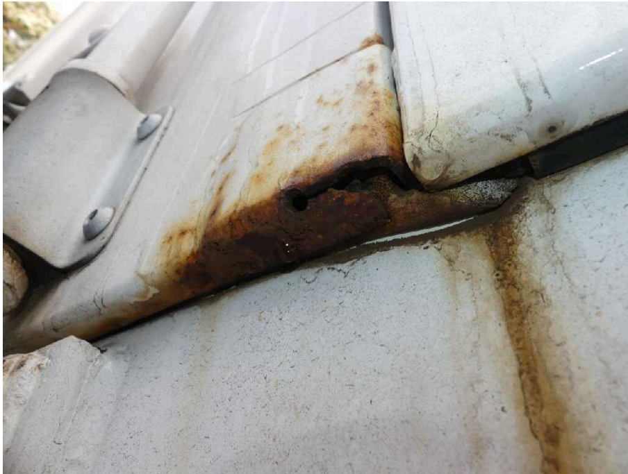
Bild 21 Fahrzeugheck Heckflügeltür links stark korrodiert und keine fachgerechte Reparatur
