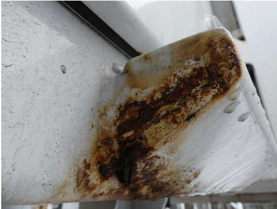
Bild 31 Fahrzeugheck Rahmen hinten rechts stark korrodiert
