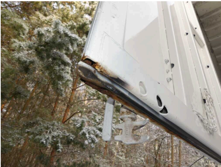
Bild 24 Fahrzeugheck Heckflügeltür links stark korrodiert und keine fachgerechte Reparatur
