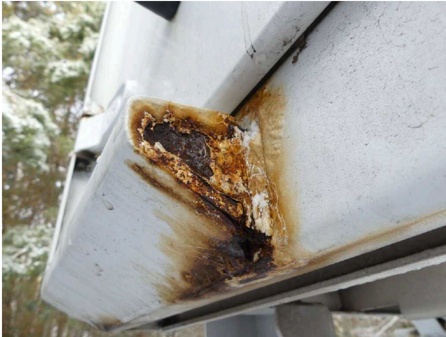
Bild 13 Fahrzeugheck Rahmen hinten links stark korrodiert
