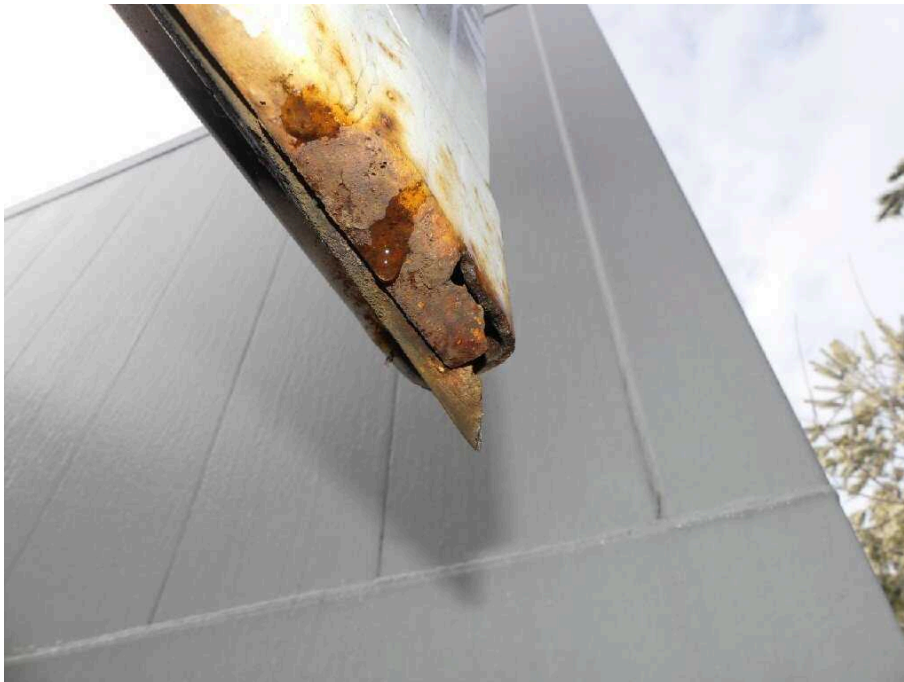
Bild 27 Fahrzeugheck Heckflügeltür links stark korrodiert und keine fachgerechte Reparatur
