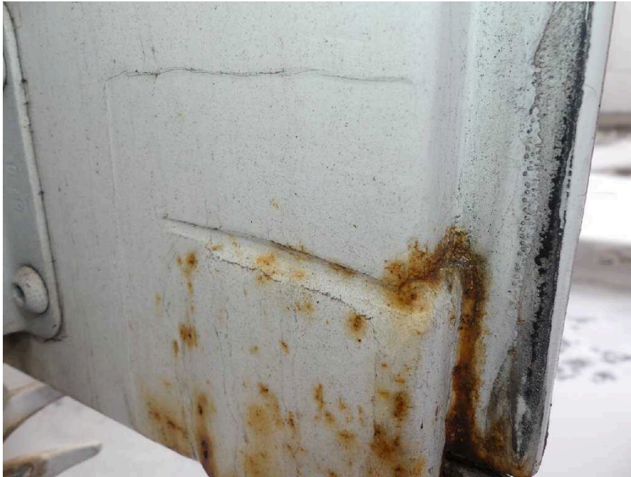
Bild 25 Fahrzeugheck Heckflügeltür links stark korrodiert und keine fachgerechte Reparatur
