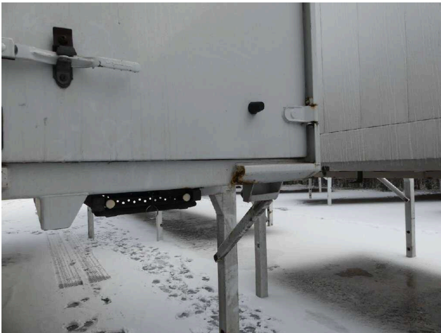
Bild 30 Fahrzeugheck Rahmen hinten rechts stark korrodiert
