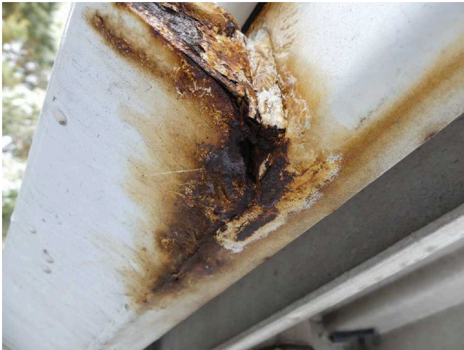
Bild 15 Fahrzeugheck Rahmen hinten links stark korrodiert
