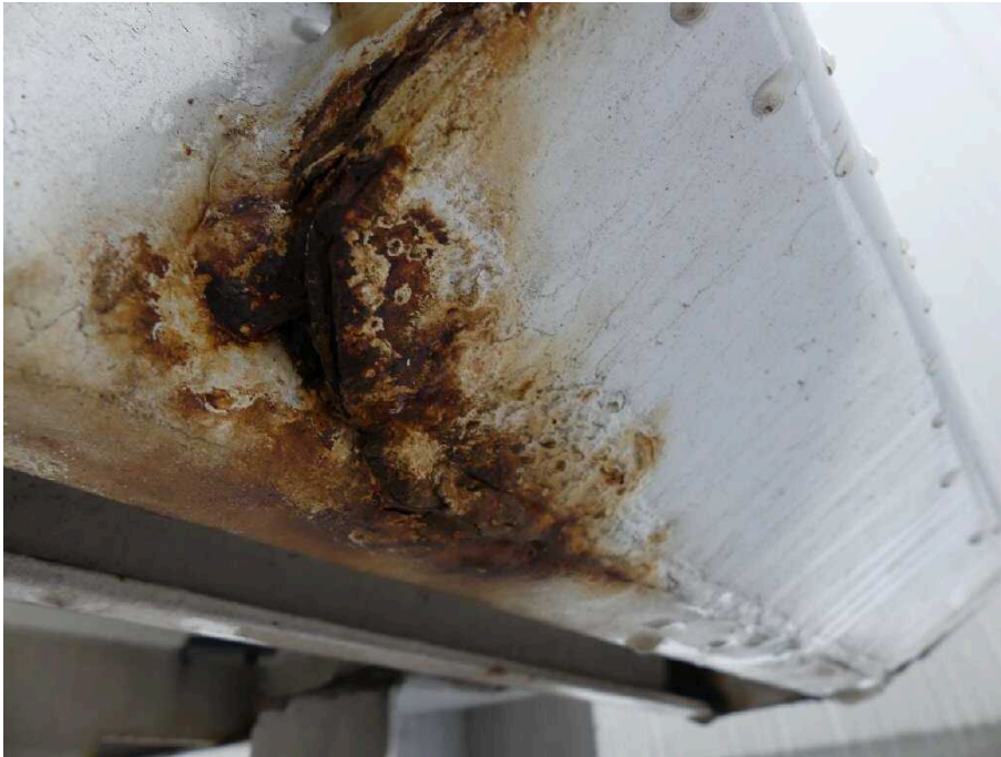
Bild 33 Fahrzeugheck Rahmen hinten rechts stark korrodiert
