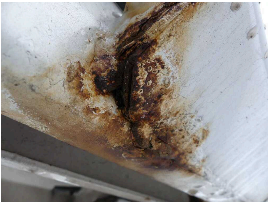
Bild 32 Fahrzeugheck Rahmen hinten rechts stark korrodiert
