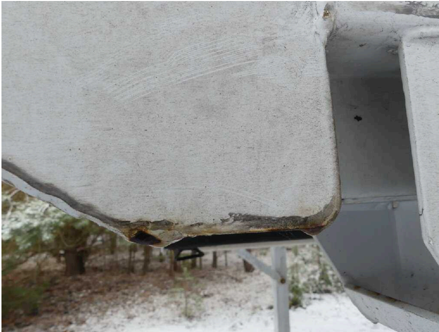
Bild 37 Fahrzeugheck Ecksäule hinten rechts verschürft
