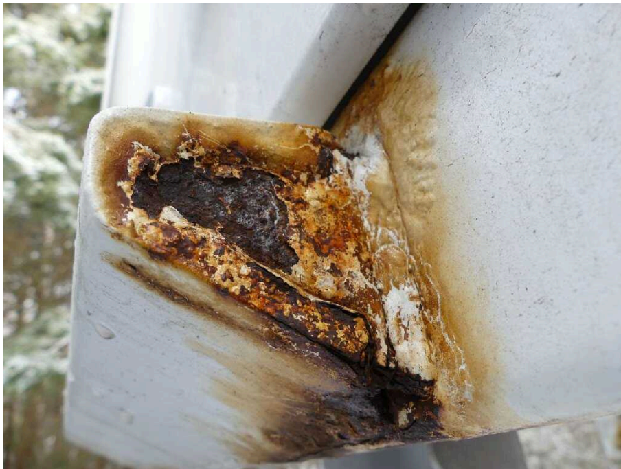
Bild 14 Fahrzeugheck Rahmen hinten links stark korrodiert
