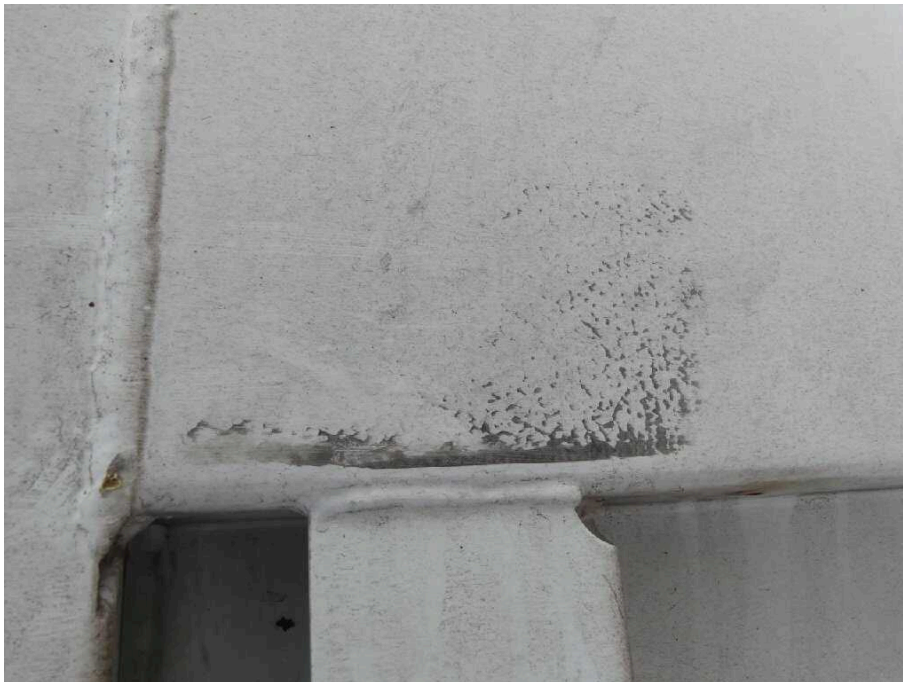
Bild 39 Fahrzeugheck Ecksäule hinten rechts verschürft
