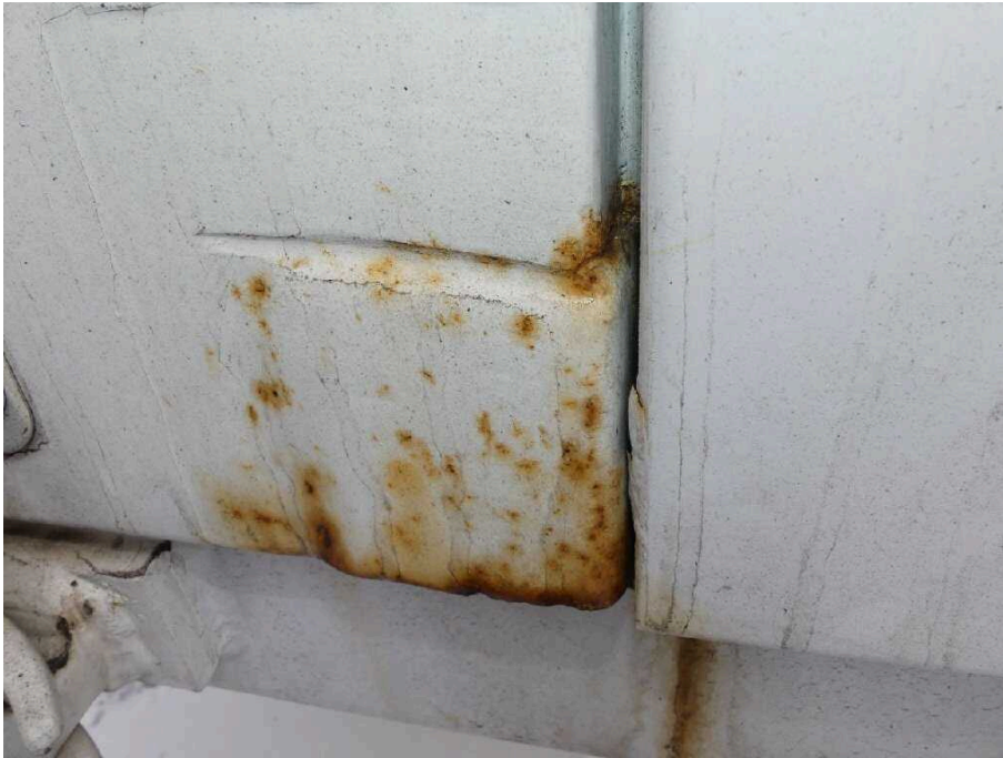
Bild 23 Fahrzeugheck Heckflügeltür links stark korrodiert und keine fachgerechte Reparatur
