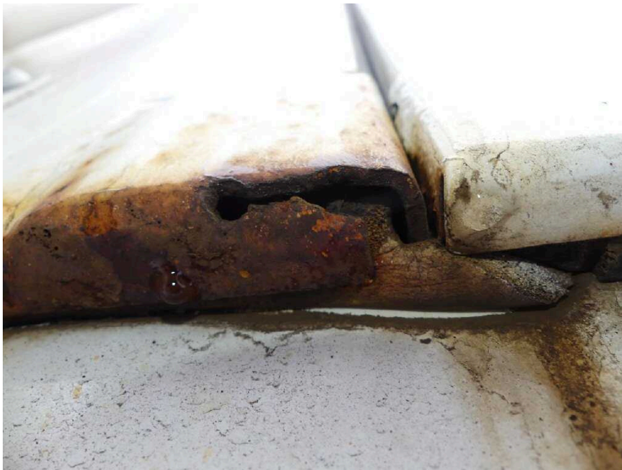
Bild 22 Fahrzeugheck Heckflügeltür links stark korrodiert und keine fachgerechte Reparatur
