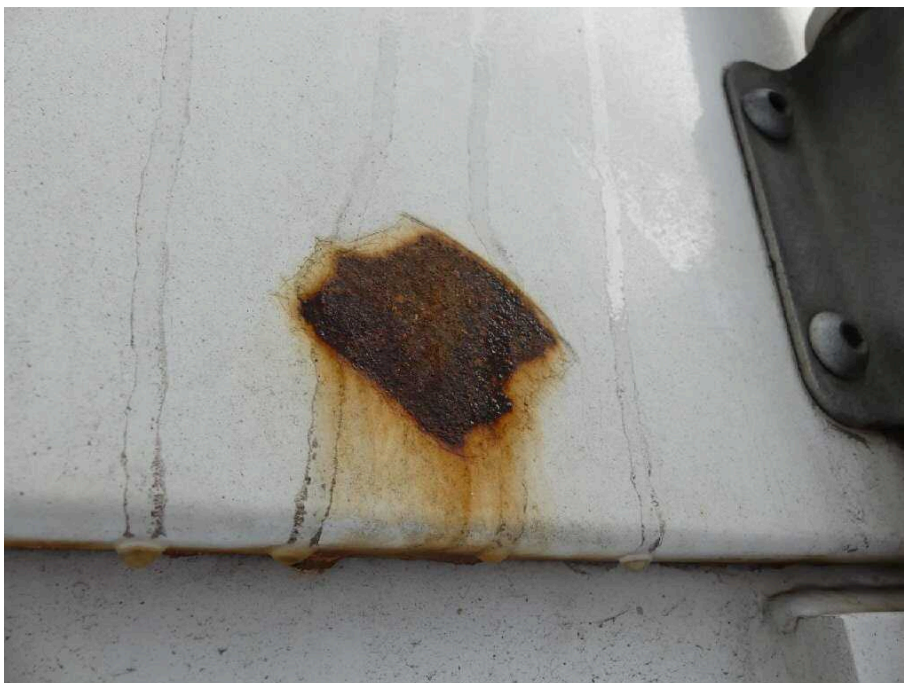
Bild 18 Fahrzeugheck Heckflügeltür links stark korrodiert und keine fachgerechte Reparatur
