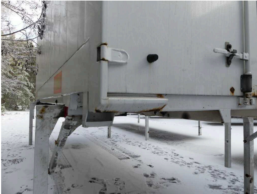
Bild 11 Fahrzeugheck Rahmen hinten links stark korrodiert
