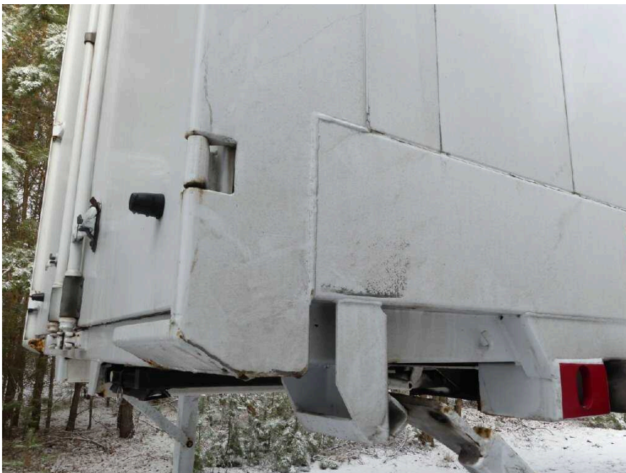
Bild 36 Fahrzeugheck Ecksäule hinten rechts verschürft
