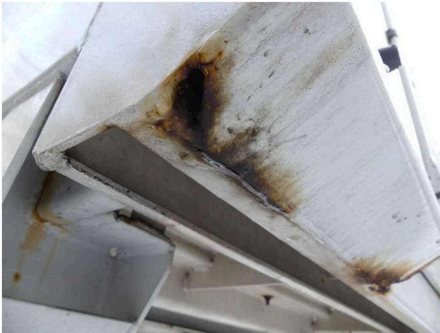
Bild 12 Fahrzeugheck Rahmen hinten links stark korrodiert
