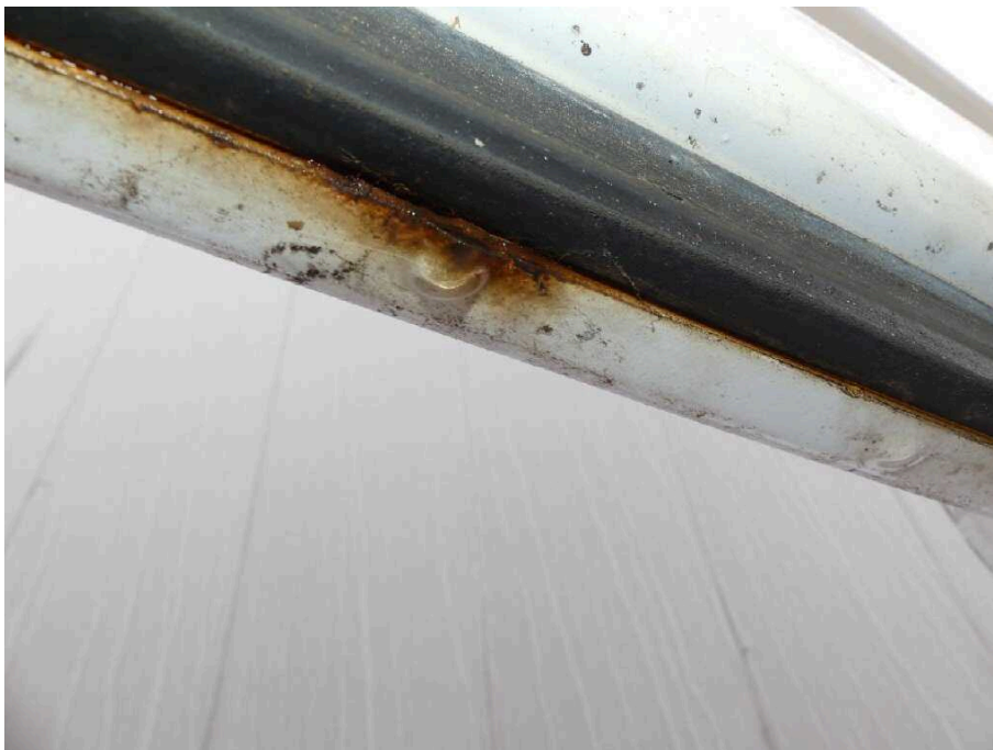
Bild 42 Fahrzeugheck Heckflügeltür rechts korrodiert
