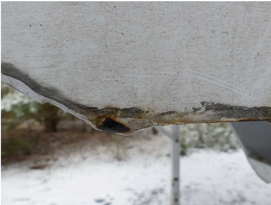
Bild 38 Fahrzeugheck Ecksäule hinten rechts verschürft
