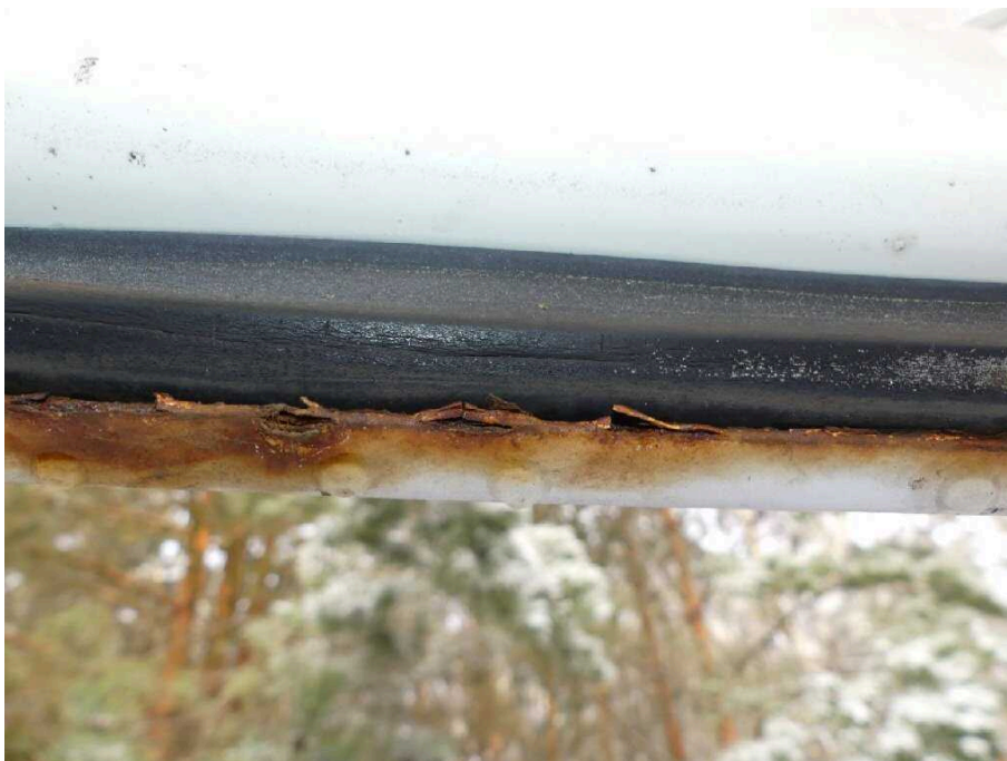
Bild 28 Fahrzeugheck Heckflügeltür links stark korrodiert und keine fachgerechte Reparatur
