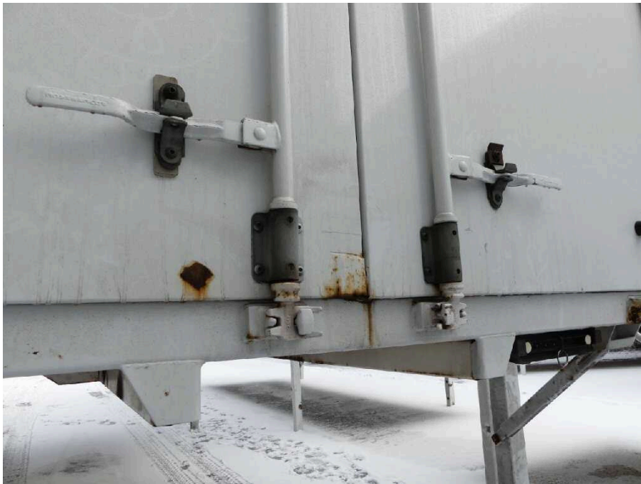
Bild 17 Fahrzeugheck Heckflügeltür links stark korrodiert und keine fachgerechte Reparatur
