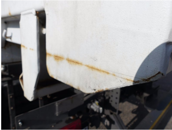
Bild 19: Eckbeplankung links Korrosion - instandsetzen und lackieren
