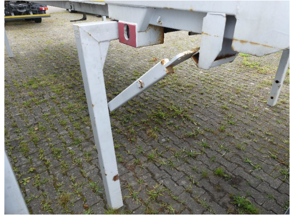
Bild 40: Stützen rundum Korrosion-instandsetzen und lackieren
