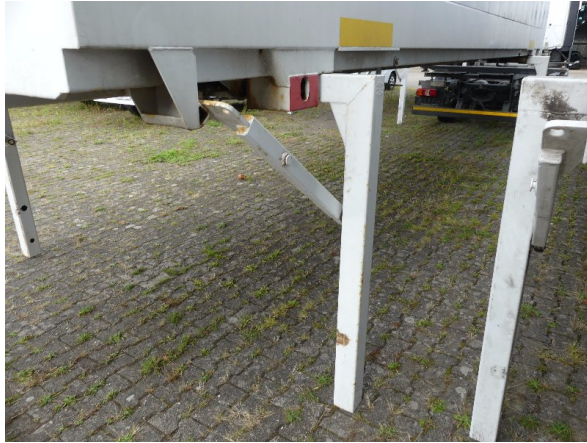
Bild 39: Stützen rundum Korrosion-instandsetzen und lackieren
