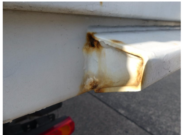
Bild 22: Eckbeplankung rechts Korrosion - instandsetzen und lackieren
