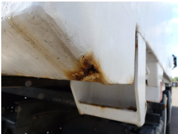
Bild 21: Eckbeplankung rechts Korrosion - instandsetzen und lackieren
