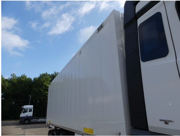
Bild 23: Seitenwand Lackmangel - lackieren
