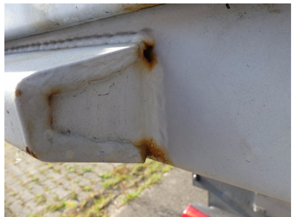
Bild 18: Eckbeplankung links Korrosion - instandsetzen und lackieren
