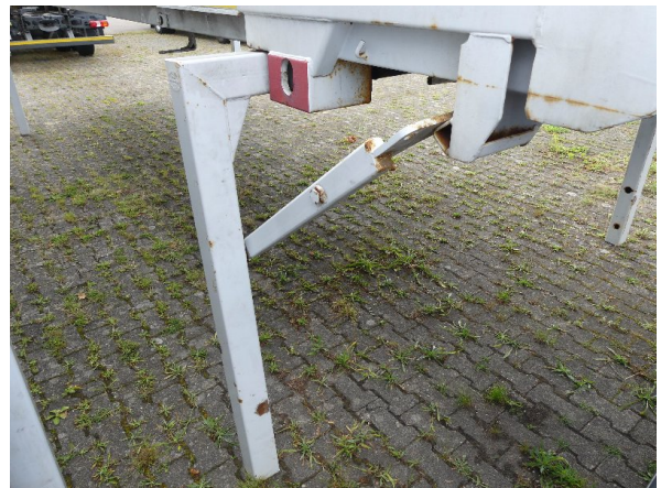
Bild 32: Stützen rundum Korrosion - instandsetzen und lackieren
