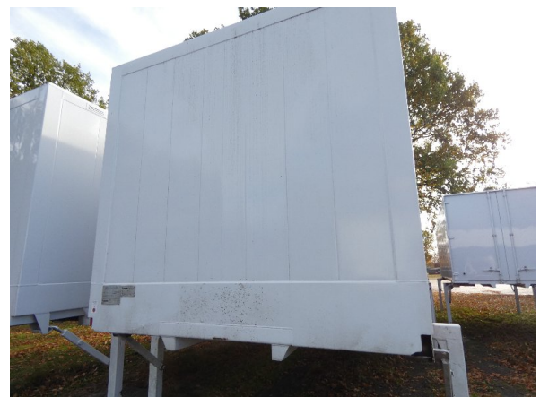
Bild 12: Stirnwand Korrosion - instandsetzen und lackieren
