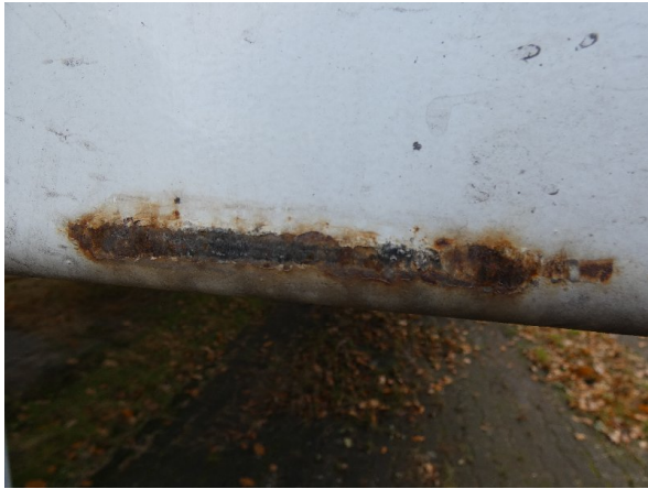
Bild 13: Stirnwand Korrosion - instandsetzen und lackieren
