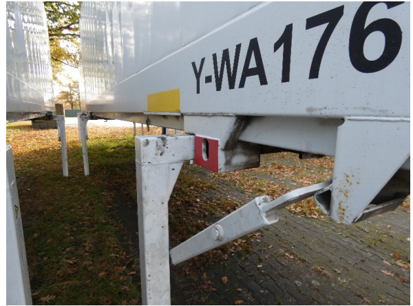
Bild 14: Seitenwand Korrosion - instandsetzen und lackieren
