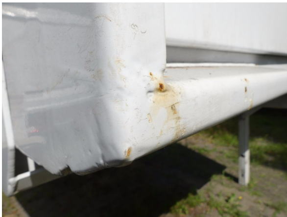
Bild 21: Heckbereich Korrosion - instandsetzen und lackieren
