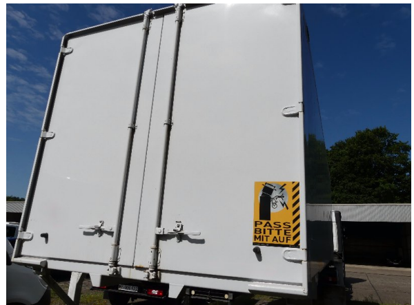
Bild 22: Hecktür rechts Korrosion - instandsetzen und lackieren
