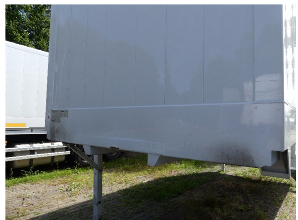
Bild 12: Frontwand Korrosion - instandsetzen und lackieren
