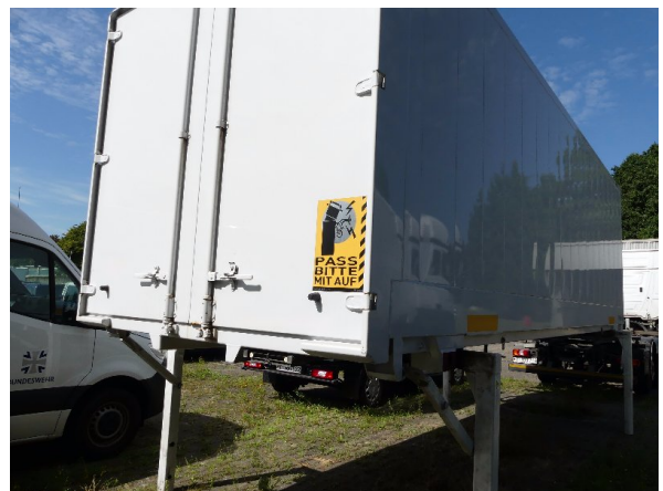
Bild 18: Heckbereich Korrosion - instandsetzen und lackieren
