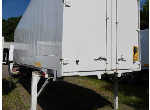
Bild 20: Heckbereich Korrosion - instandsetzen und lackieren
