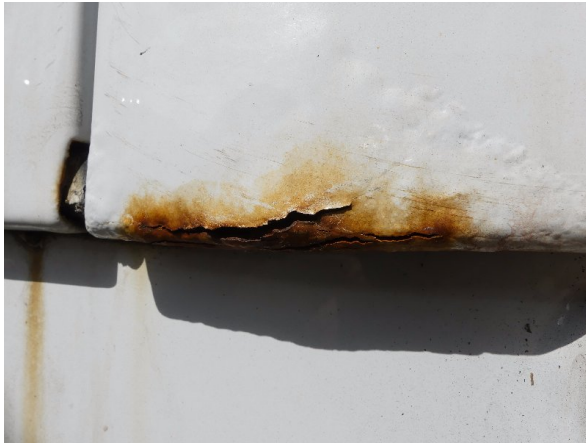
Bild 23: Hecktür rechts Korrosion - instandsetzen und lackieren
