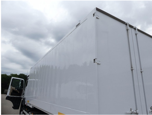
Bild 33: Karosserie / Innenraum Delle / Kratzer / Steinschlag / Abschürfung-ohne Reparatur
