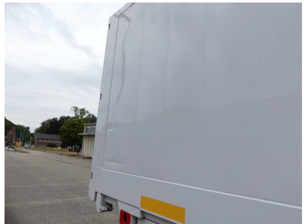
Bild 22: Seitenwand DelleKratzer - instandsetzen und lackieren
