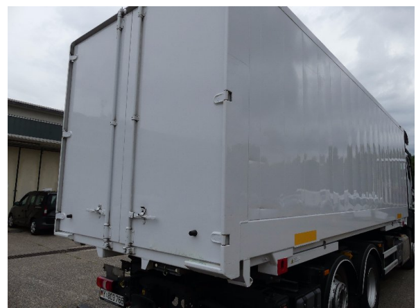
Bild 12: Eckbeplankung rechts Korrosion - instandsetzen und lackieren
