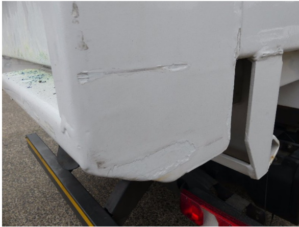
Bild 13: Eckbeplankung rechts Korrosion - instandsetzen und lackieren
