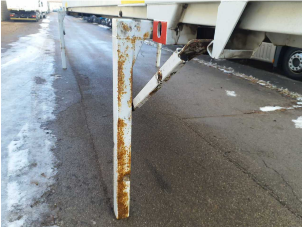
Beschädigung 1: Aufbau: Aufbau - Korrosion - instandsetzen und lackieren
