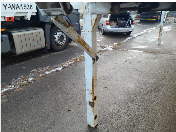
Beschädigung 1: Aufbau: Aufbau - Korrosion - instandsetzen und lackieren
