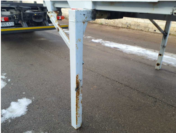
Beschädigung 1: Aufbau: Aufbau - Korrosion - instandsetzen und lackieren
