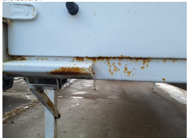
Beschädigung 1: Aufbau: Aufbau - Korrosion - instandsetzen und lackieren
