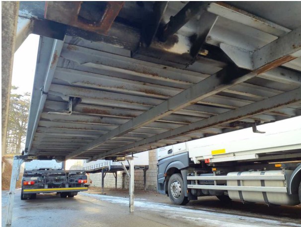
Beschädigung 1: Karosserie: Karosserie - Korrosion - instandsetzen und lackieren
