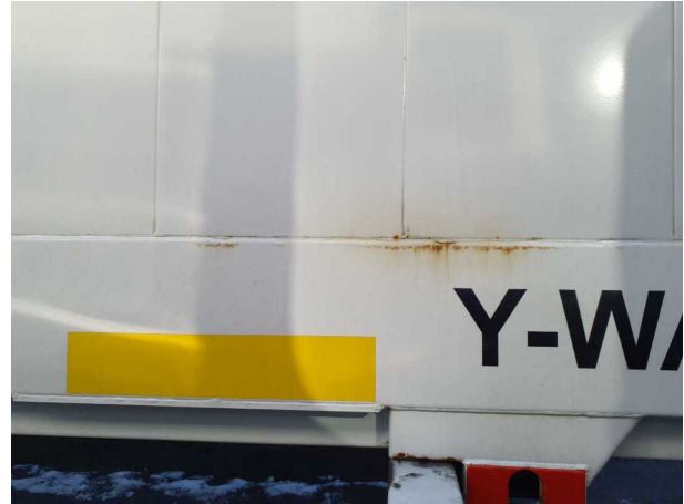
Beschädigung 1: Karosserie: Karosserie - Korrosion - instandsetzen und lackieren
