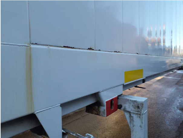
Beschädigung 1: Karosserie: Karosserie - Korrosion - instandsetzen und lackieren
