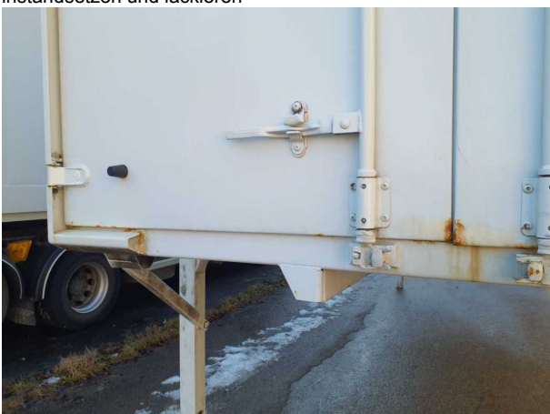
Beschädigung 1: Karosserie: Karosserie - Korrosion - instandsetzen und lackieren
