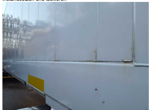
Beschädigung 1: Karosserie: Karosserie - Korrosion - instandsetzen und lackieren
