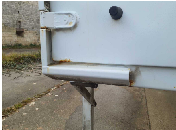
Beschädigung 1: Aufbau: Aufbau - Korrosion - instandsetzen und lackieren
