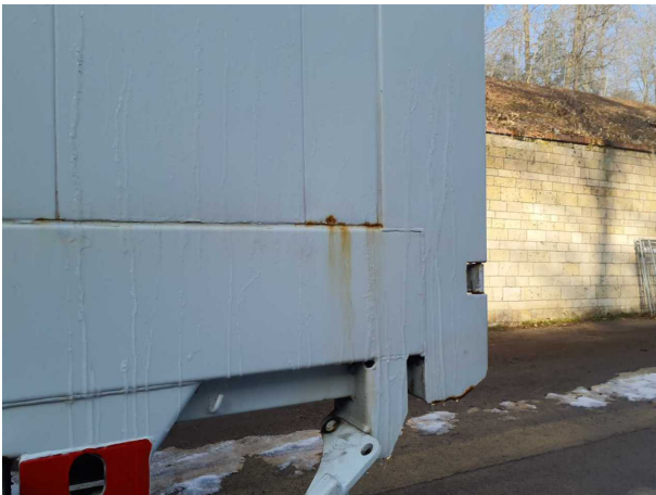
Beschädigung 1: Aufbau: Aufbau - Korrosion - instandsetzen und lackieren
