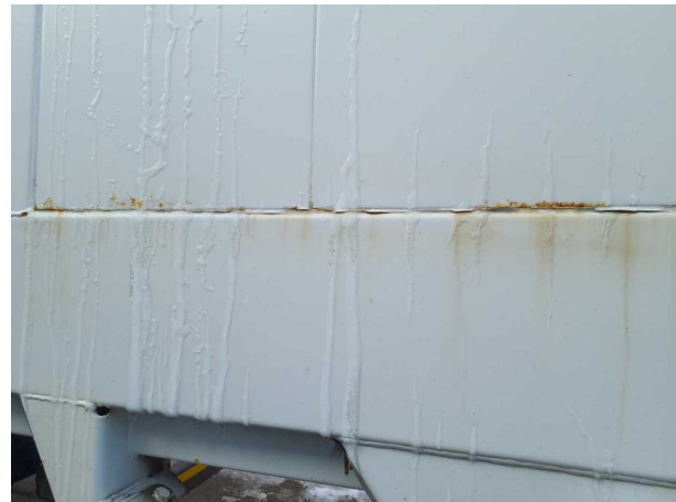
Beschädigung 1: Aufbau: Aufbau - Korrosion - instandsetzen und lackieren
