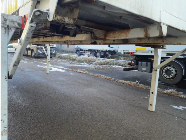
Beschädigung 1: Aufbau: Aufbau - Korrosion - instandsetzen und lackieren
