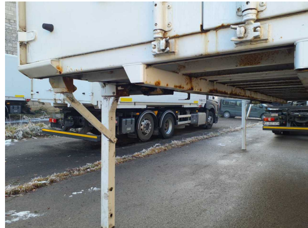
Beschädigung 1: Aufbau: Aufbau - Korrosion - instandsetzen und lackieren
