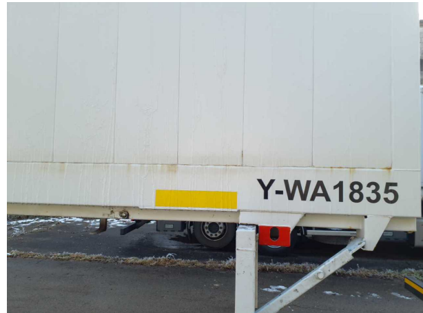
Beschädigung 1: Aufbau: Aufbau - Korrosion - instandsetzen und lackieren
