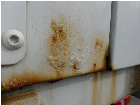
Bild 29: Hecktür links Korrosion - instandsetzen und lackieren
