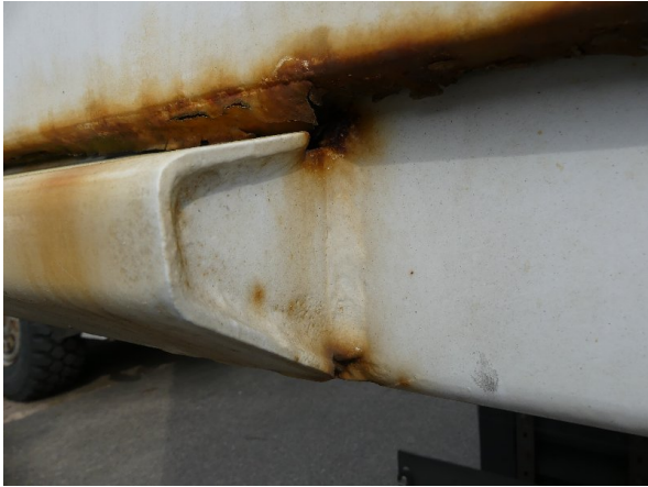
Bild 25: Eckbeplankung links Korrosion - instandsetzen und lackieren
