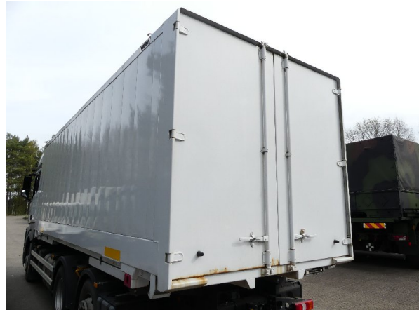
Bild 28: Hecktür links Korrosion - instandsetzen und lackieren
