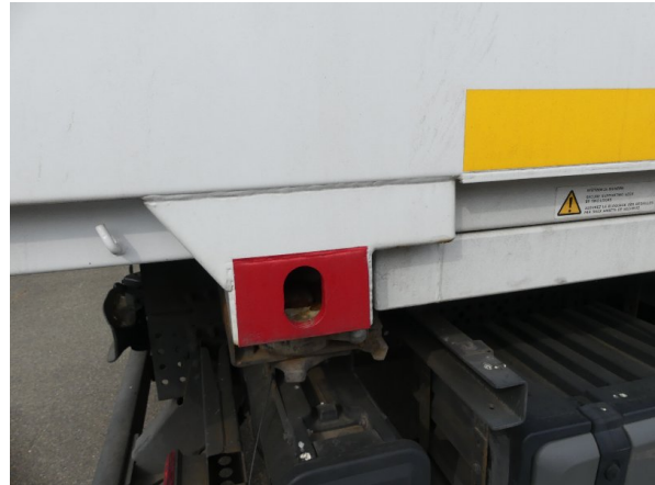
Bild 16: Aufnahmen hinten rechts, hinten links und vorne links Korrosion - instandsetzen und lackieren
