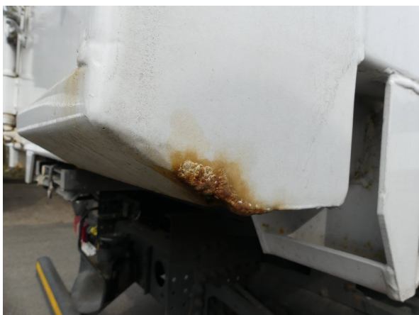
Bild 23: Eckbeplankung rechts Korrosion - instandsetzen und lackieren
