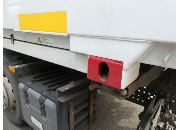
Bild 18: Aufnahmen hinten rechts, hinten links und vorne links Korrosion - instandsetzen und lackieren
