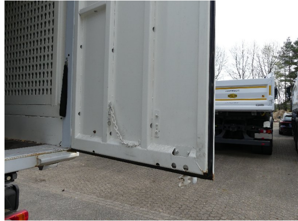
Bild 26: Hecktür rechts Korrosion - instandsetzen und lackieren
