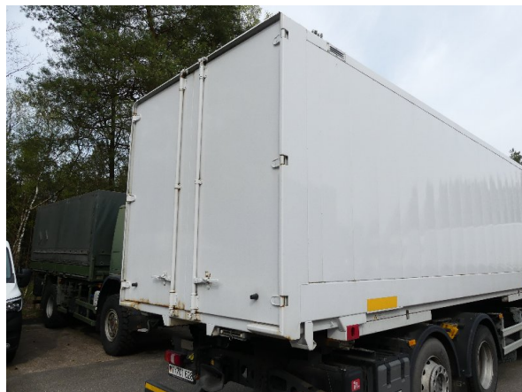
Bild 22: Eckbeplankung rechts Korrosion - instandsetzen und lackieren
