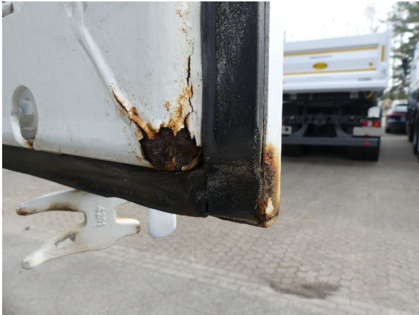
Bild 27: Hecktür rechts Korrosion - instandsetzen und lackieren
