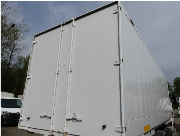
Bild 21: Tür rechts Korrosion - instandsetzen und lackieren
