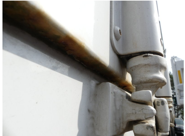
Bild 24: Hecktür links Korrosion - instandsetzen und lackieren
