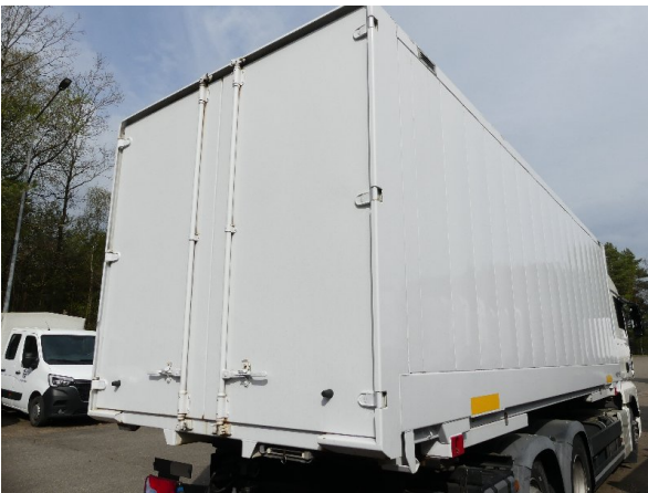
Bild 15: Eckbeplankung rechts Korrosion - instandsetzen und lackieren
