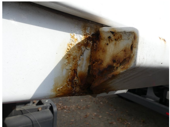
Bild 16: Eckbeplankung rechts Korrosion - instandsetzen und lackieren
