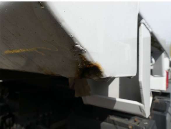
Bild 17: Eckbeplankung rechts Korrosion - instandsetzen und lackieren
