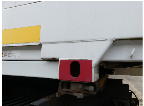
Bild 24: Aufnahmen links Korrosion - instandsetzen und lackieren
