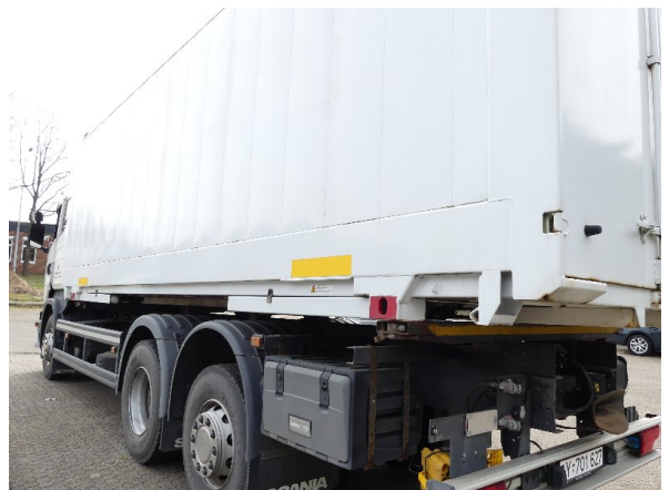
Bild 18: Abdichtung Seitenwände beschädigt - erneuern
