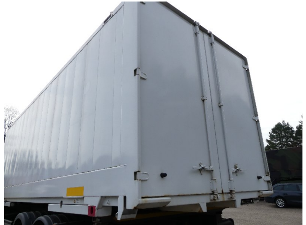
Bild 14: Hecktür links Korrosion - instandsetzen und lackieren
