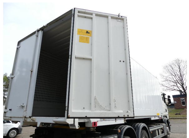
Bild 12: Hecktür rechts Korrosion - instandsetzen und lackieren
