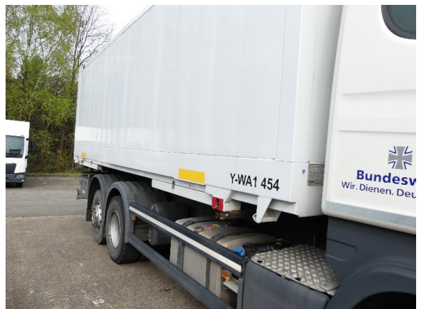
Bild 16: Abdichtung Seitenwände beschädigt - erneuern
