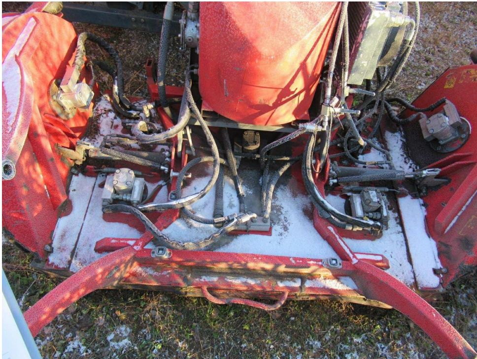
Bild 5 : Rahmen mitte verbogen
