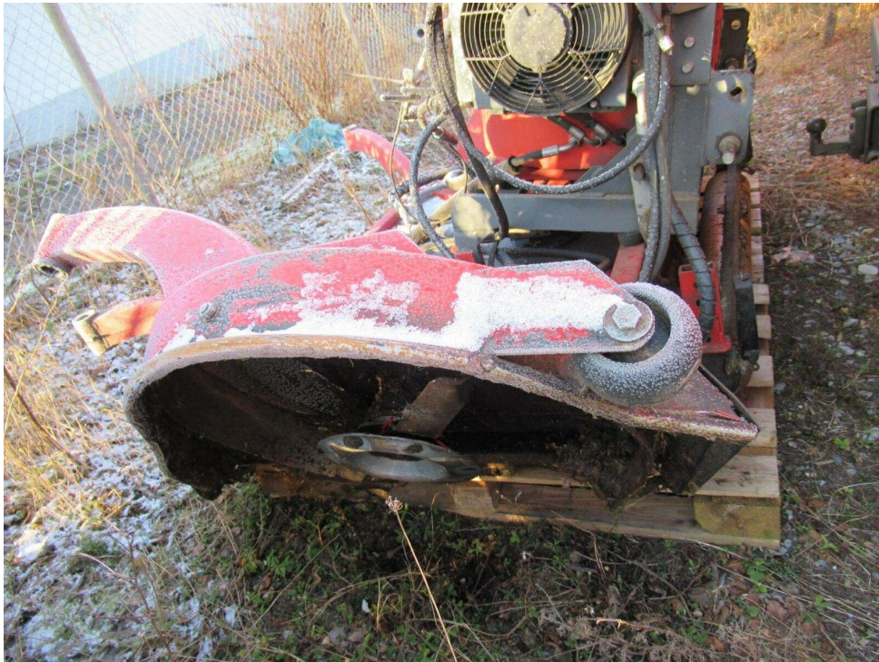
Bild 3 : Mähwerk v verschlissen
