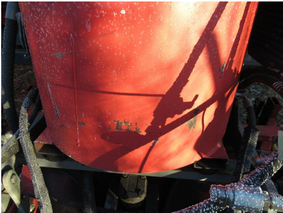
Bild 8 : Gehäuse verschrammt, Rost
