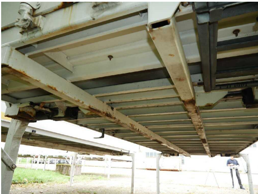
Bild 9 Fahrzeugfront Längsträger links und rechts korrodiert
