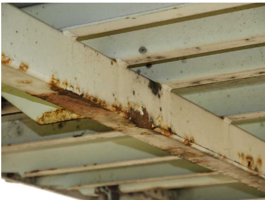
Bild 10 Fahrzeugfront Längsträger links und rechts korrodiert
