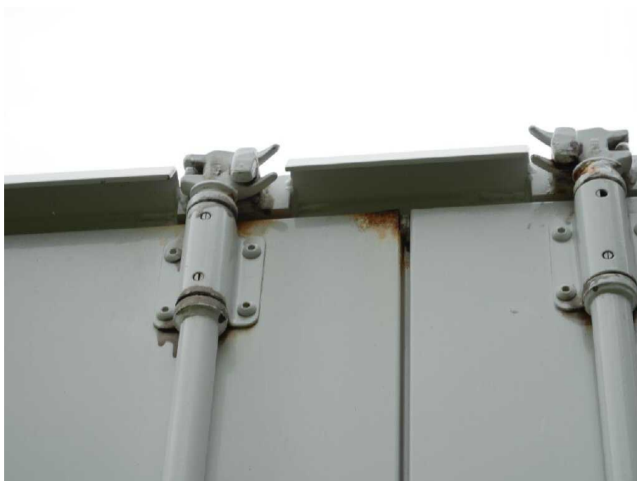
Bild 12 linke Seite Tür hinten links korrodiert
