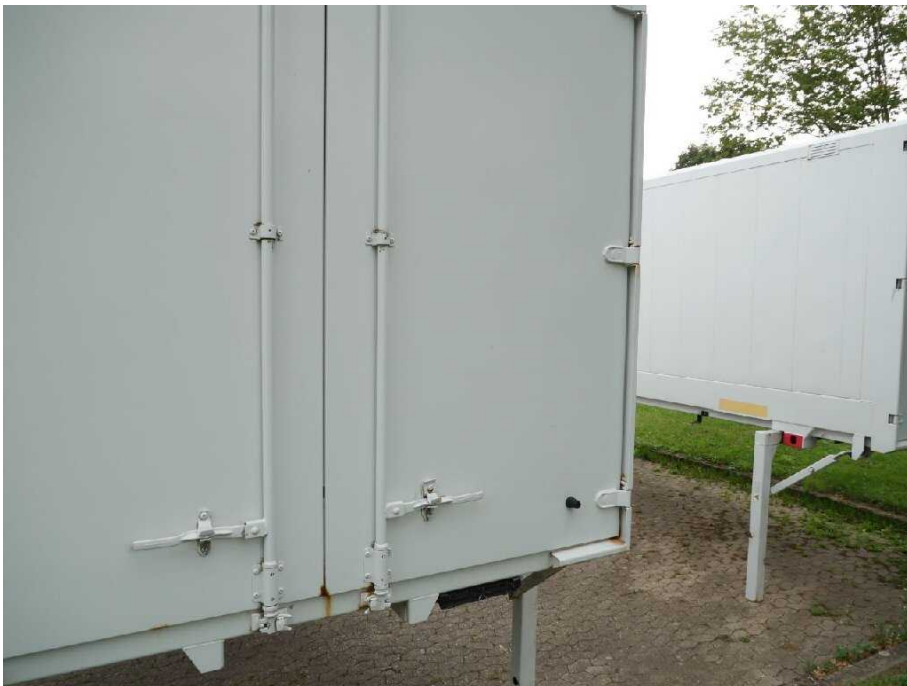
Bild 13 Fahrzeugheck Tür hinten rechts korrodiert
