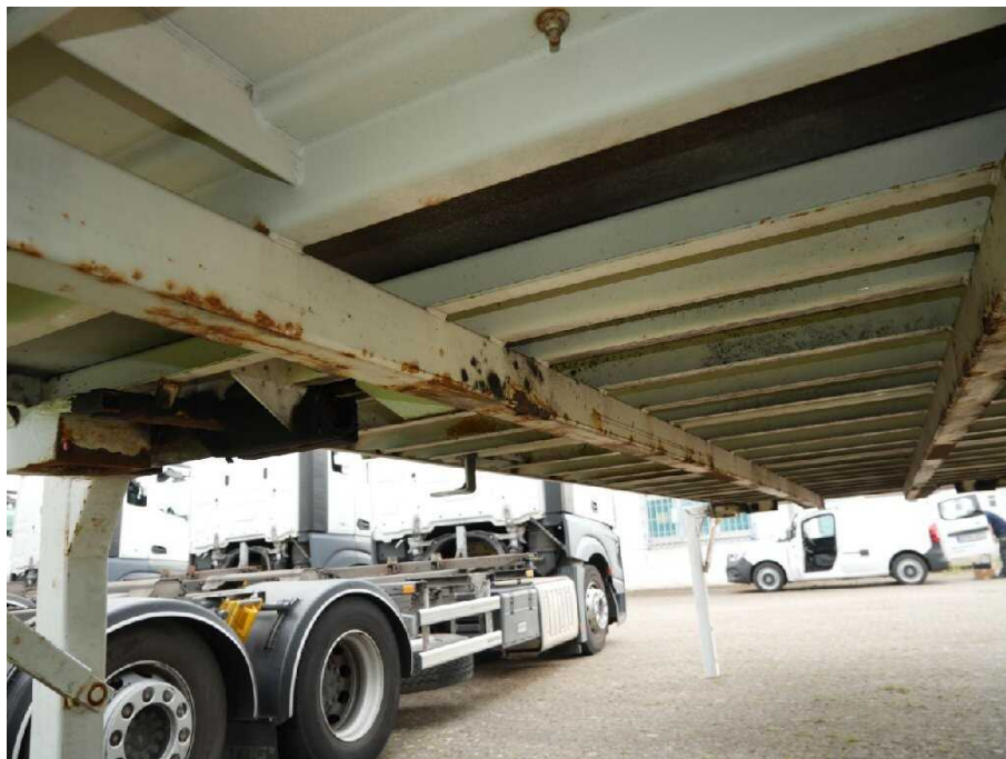
Bild 15 Fahrzeugfront Längsträger links und rechts korrodiert
