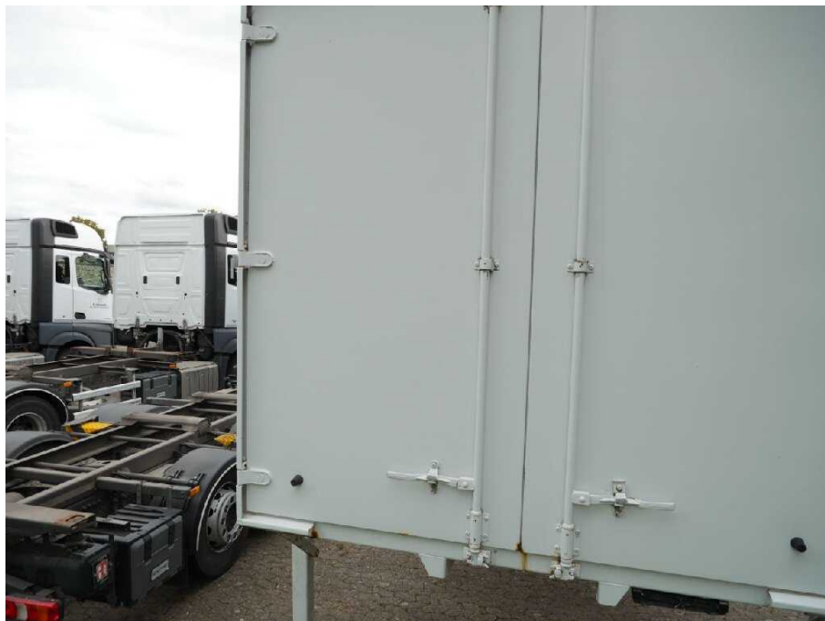
Bild 9 linke Seite Tür hinten links korrodiert
