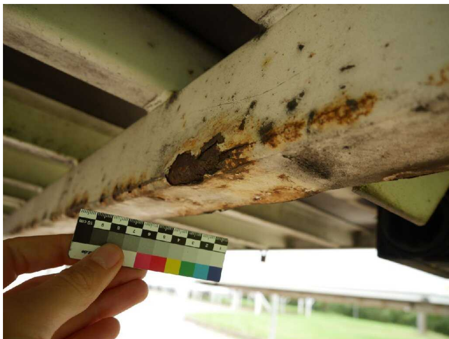
Bild 18 Fahrzeugfront Längsträger links und rechts korrodiert
