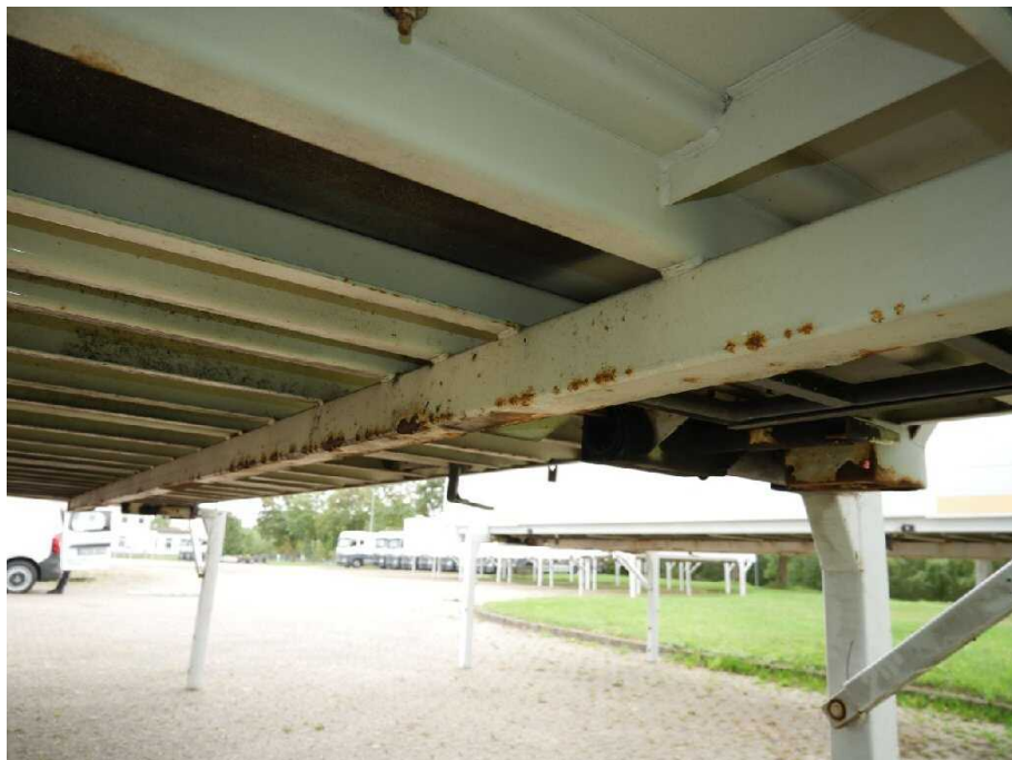
Bild 17 Fahrzeugfront Längsträger links und rechts korrodiert
