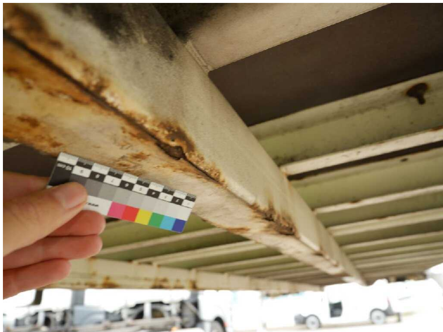
Bild 19 Fahrzeugfront Längsträger links und rechts korrodiert
