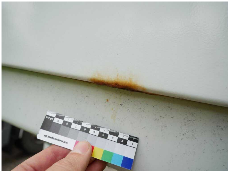
Bild 11 linke Seite Tür hinten links korrodiert
