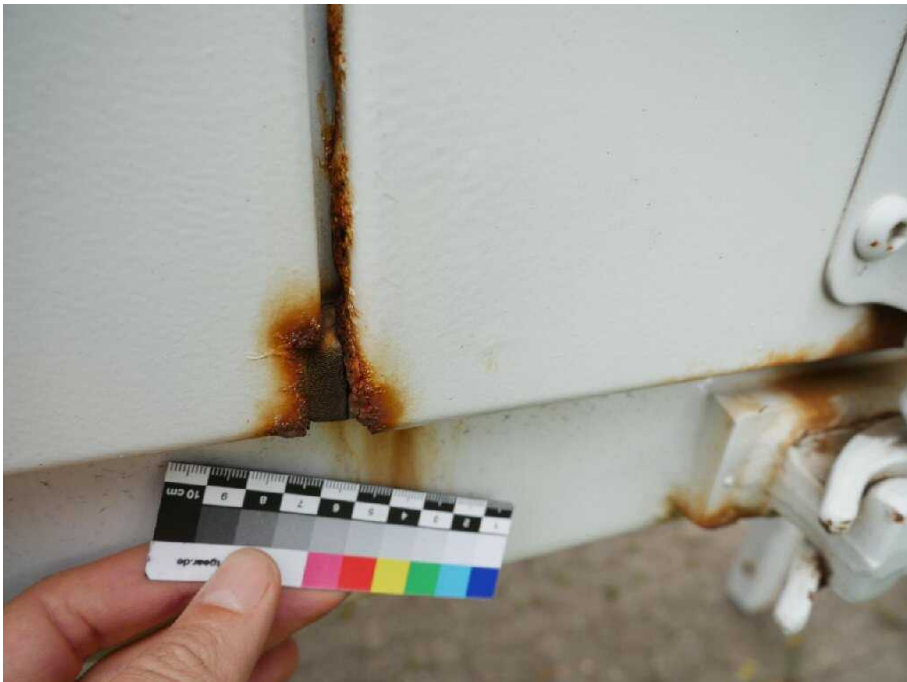
Bild 14 Fahrzeugheck Tür hinten rechts korrodiert
