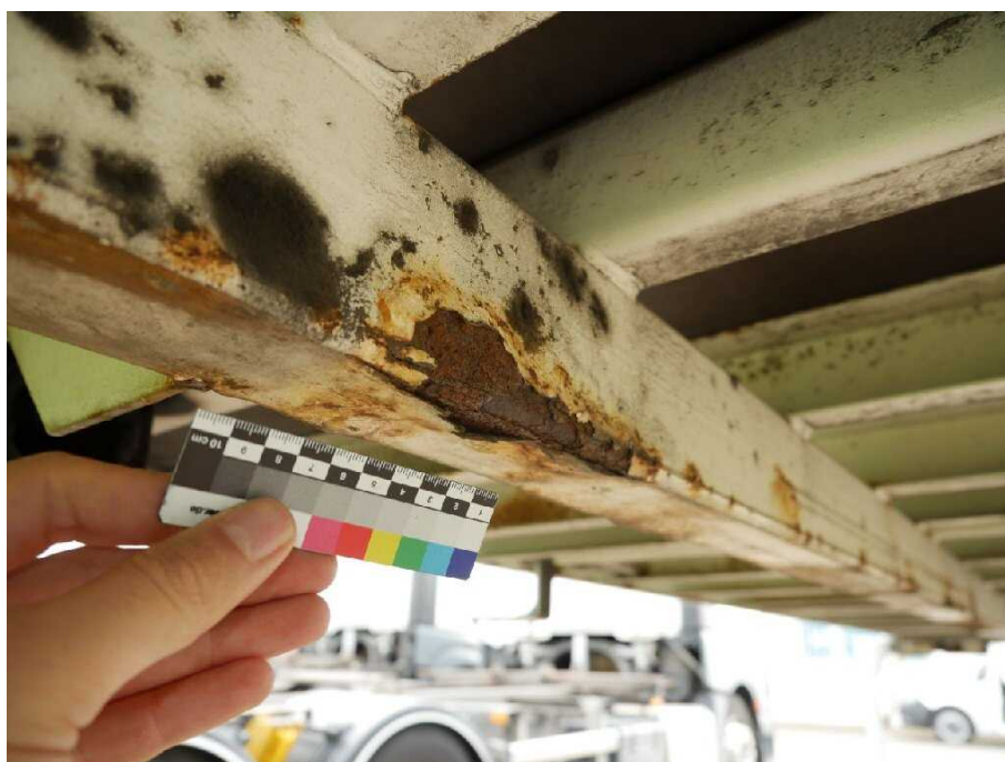
Bild 16 Fahrzeugfront Längsträger links und rechts korrodiert
