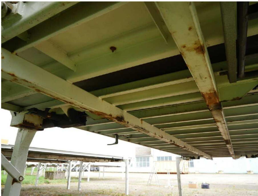
Bild 13 Fahrzeugfront Längsträger links und rechts korrodiert
