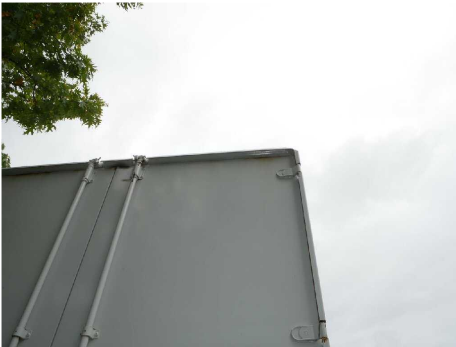
Bild 9 rechte Seite Tür hinten rechts korrodiert
