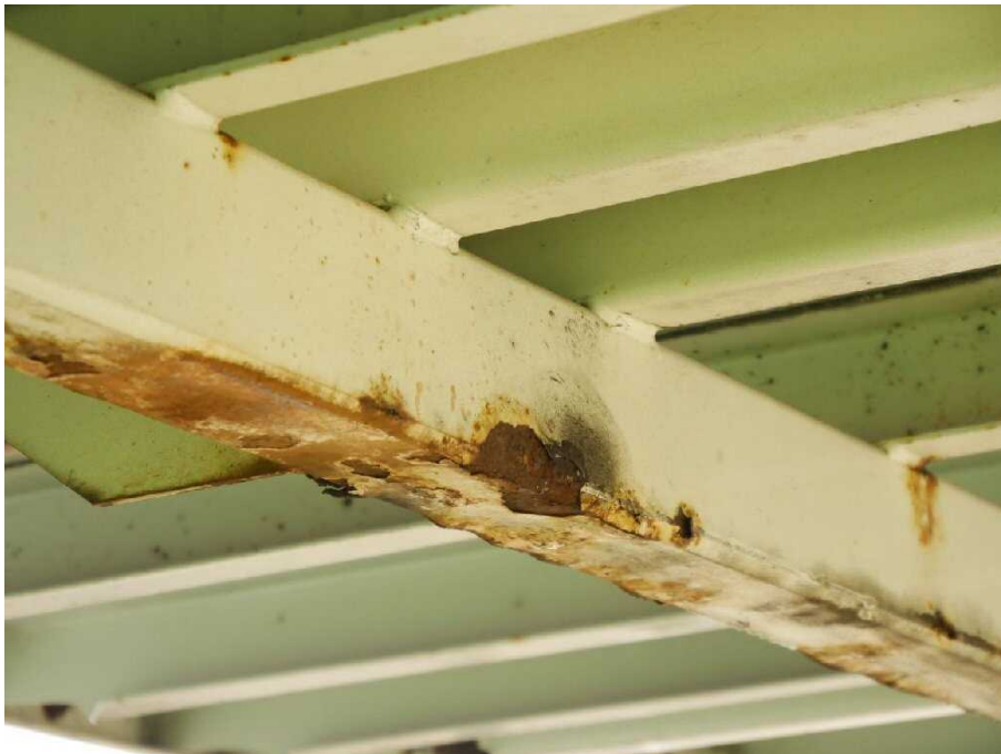
Bild 14 Fahrzeugfront Längsträger links und rechts korrodiert
