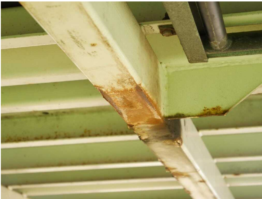
Bild 15 Fahrzeugfront Längsträger links und rechts korrodiert
