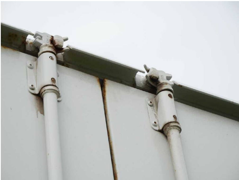
Bild 14 Fahrzeugheck Tür hinten rechts korrodiert
