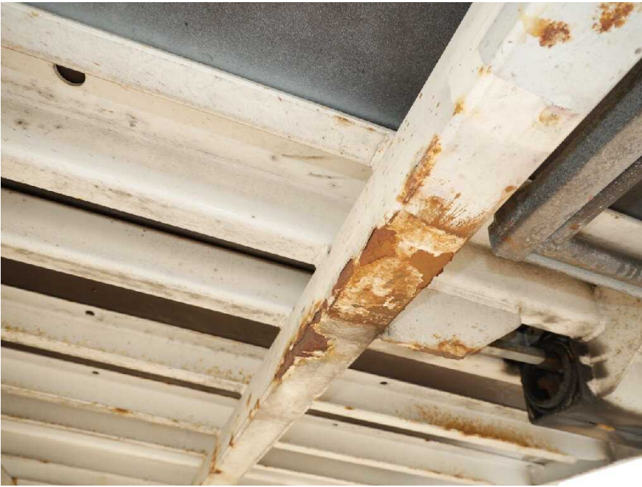
Bild 15 Fahrzeugfront Längsträger links und rechts korrodiert
