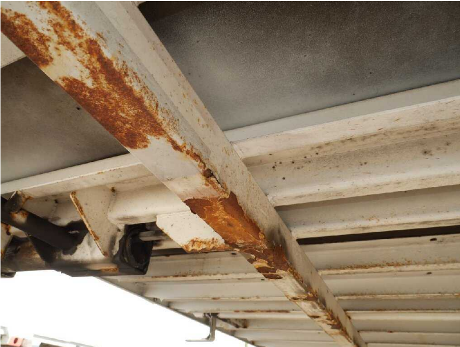
Bild 16 Fahrzeugfront Längsträger links und rechts korrodiert
