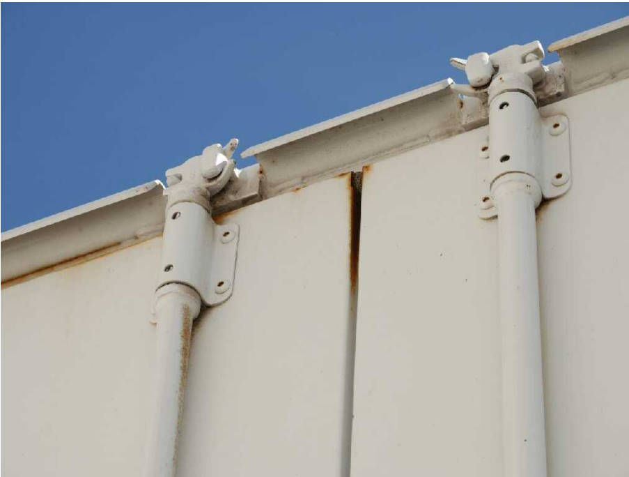
Bild 13 linke Seite Tür hinten links korrodiert
