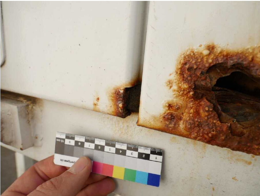
Bild 12 linke Seite Tür hinten links korrodiert
