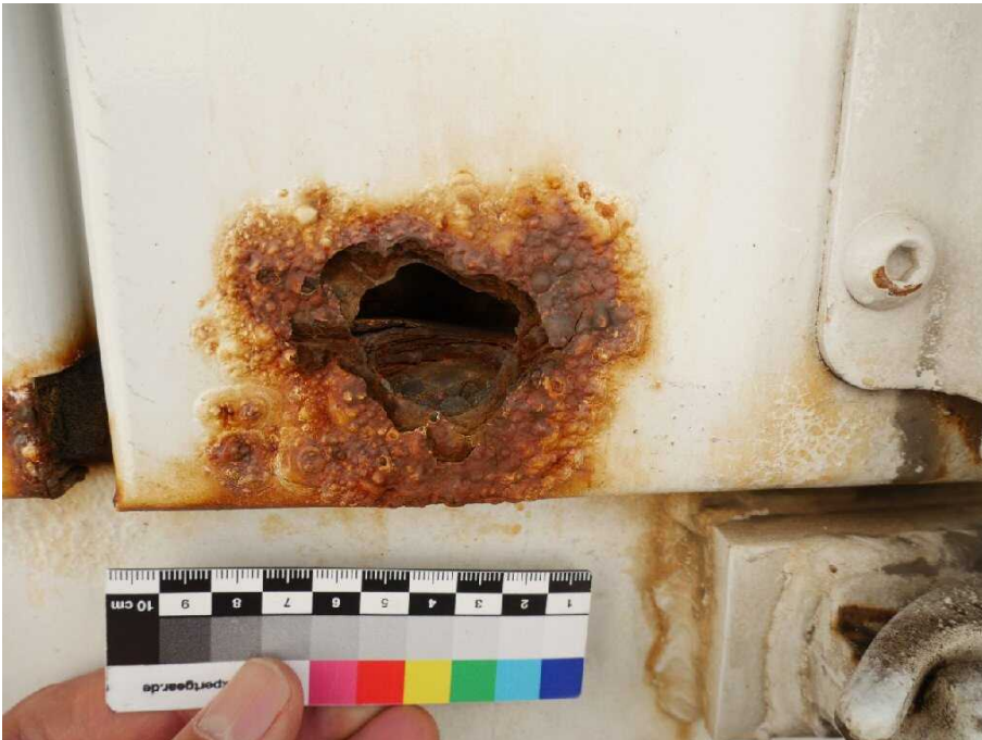
Bild 10 Fahrzeugheck Tür hinten rechts stark korrodiert
