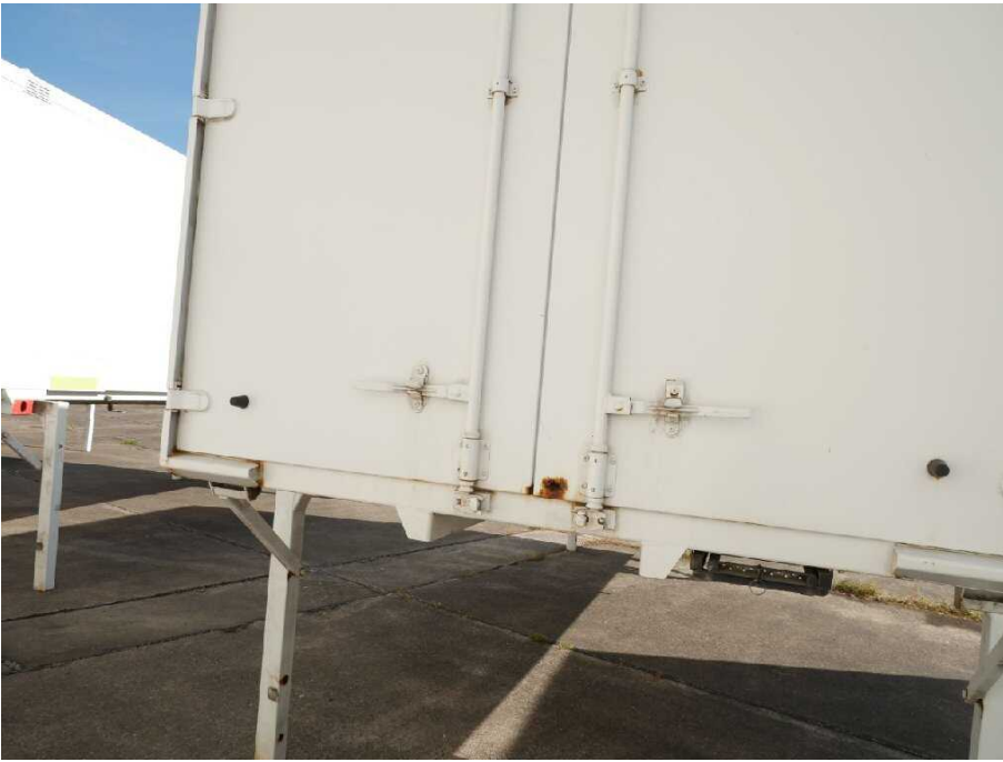
Bild 11 linke Seite Tür hinten links korrodiert
