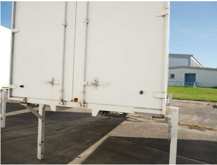
Bild 9 Fahrzeugheck Tür hinten rechts stark korrodiert
