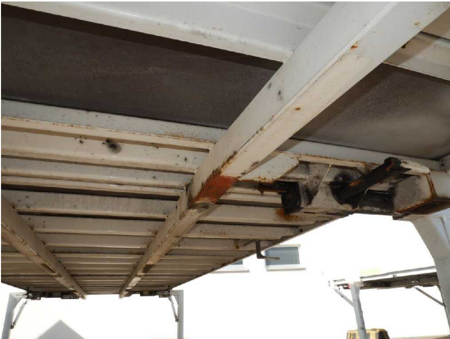
Bild 16 Fahrzeugfront Längsträger links und rechts korrodiert
