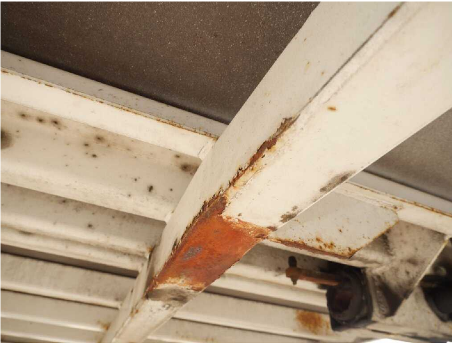
Bild 17 Fahrzeugfront Längsträger links und rechts korrodiert
