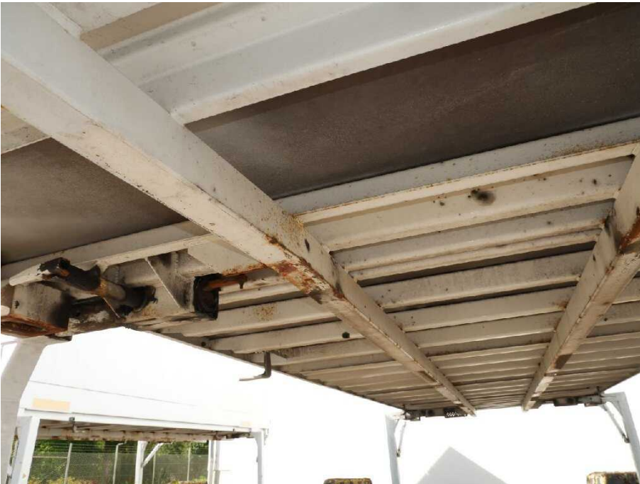
Bild 18 Fahrzeugfront Längsträger links und rechts korrodiert
