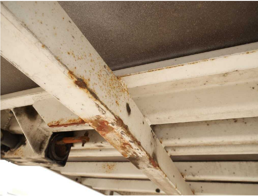
Bild 19 Fahrzeugfront Längsträger links und rechts korrodiert
