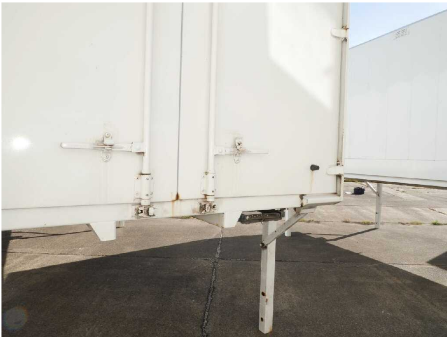
Bild 15 rechte Seite Tür hinten rechts korrodiert
