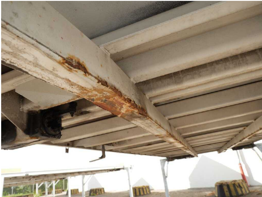
Bild 12 Fahrzeugfront Längsträger links und rechts korrodiert
