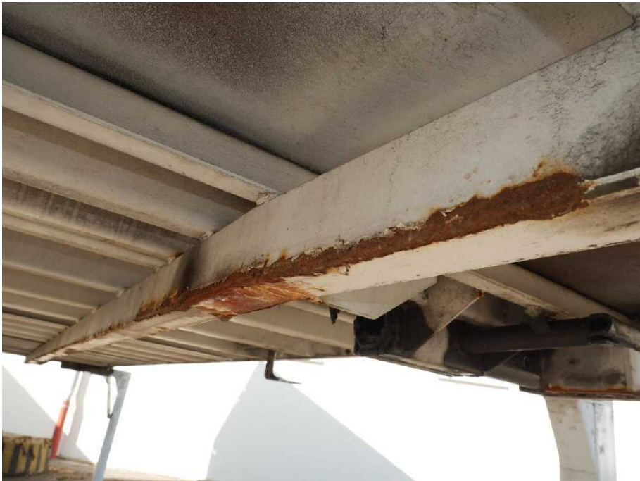
Bild 10 Fahrzeugfront Längsträger links und rechts korrodiert
