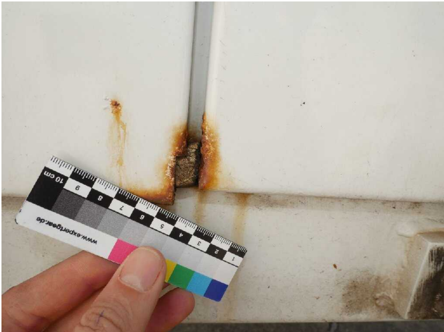
Bild 16 rechte Seite Tür hinten rechts korrodiert
