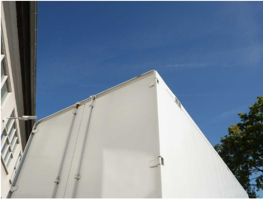
Bild 13 Dach Dachholm rechts korrodiert
