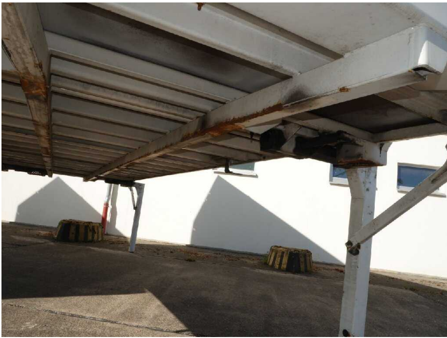
Bild 9 Fahrzeugfront Längsträger links und rechts korrodiert
