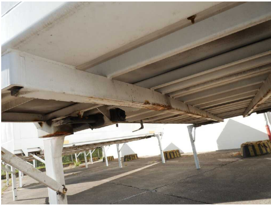
Bild 11 Fahrzeugfront Längsträger links und rechts korrodiert
