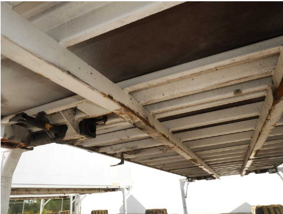
Bild 11 Fahrzeugfront Längsträger links und rechts korrodiert
