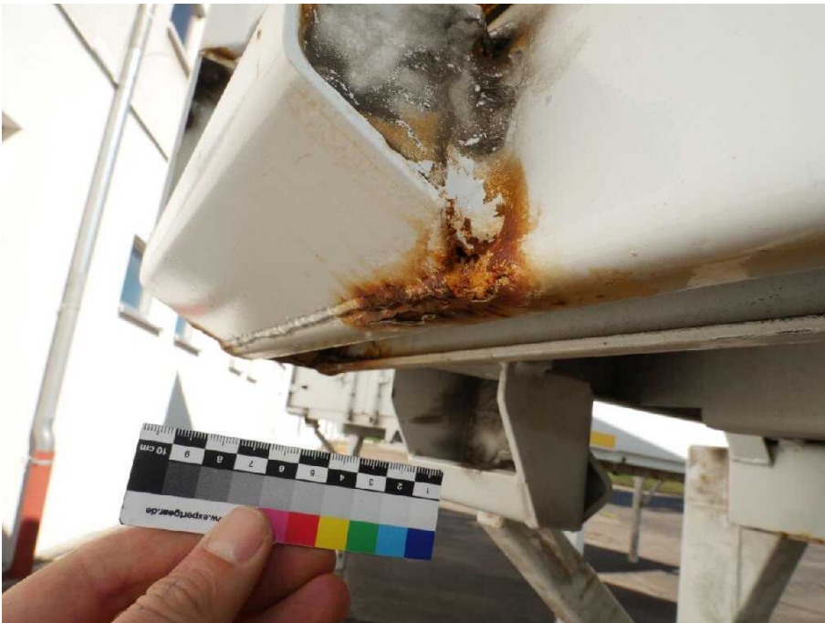
Bild 14 Aufbau Ladekante korrodiert
