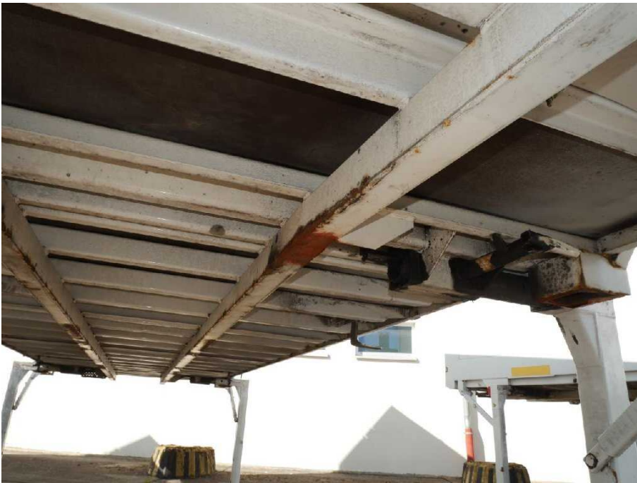
Bild 9 Fahrzeugfront Längsträger links und rechts korrodiert
