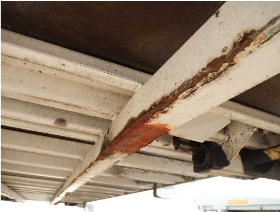
Bild 10 Fahrzeugfront Längsträger links und rechts korrodiert
