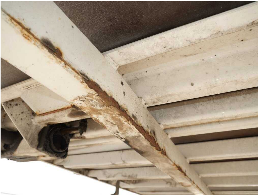
Bild 12 Fahrzeugfront Längsträger links und rechts korrodiert
