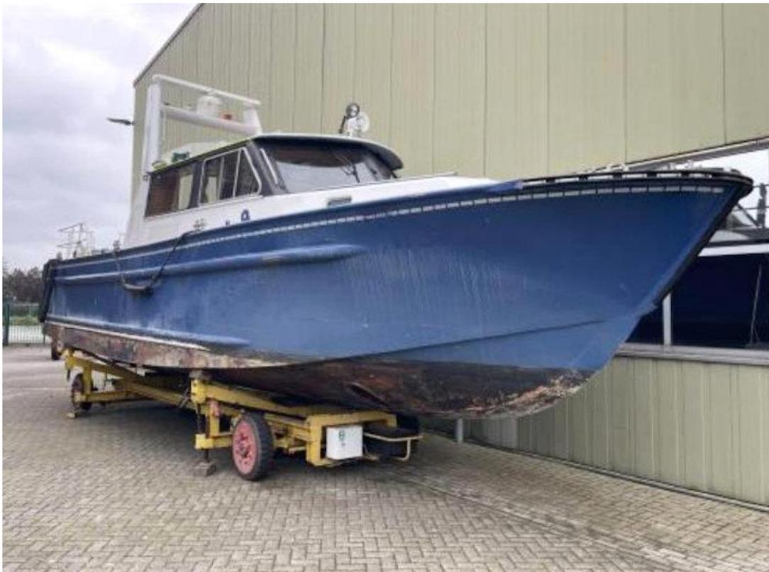
Das Wasserschutzpolizei Streifenboot (WSP) besitzt einen Rumpf und Aufbauten aus Aluminium. Es wurde von der nordrhein-westfälischen Wasserschutzpolizei im Streifendienst auf dem Rhein eingesetzt. Das WSP ist als Verdränger konzipiert und entspricht der typischen Aufteilung eines Behördenfahrzeuges.
