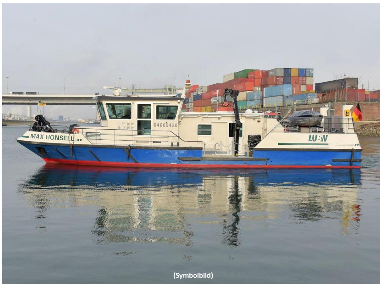
Die „Max Honsel“ war bis zur Außerdienststellung Ende Oktober 2019 für die Landesanstalt für Umwelt (LUBW) Baden-Württemberg im Bereich der Gewässeraufsicht im Einsatz und fahrbereit. Der aus Stahl gefertigte Rumpf verfügt über einen Fahrstand und Aufbauten aus Aluminium. Die „Max Honsel“ wird durch zwei Dieselmotoren über zwei Schottel Ruderpropeller angetrieben und manövriert.
