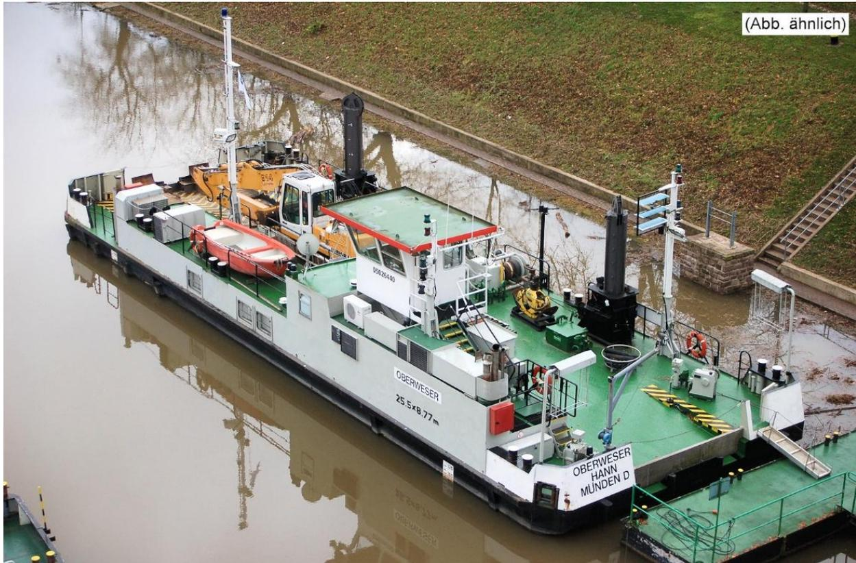
Der Schwimmgreifer Oberweser wurde im Einsatzbereich des WSA Weser im Außenbezirk Höxter zu Fahrrinnenarbeiten und strombaulichen Maßnahmen eingesetzt. Der Vortrieb des Schwimmgreifers erfolgt über zwei, durch Mercedes Benz Diesel Motoren angetriebene, Schottel Pumjets.
